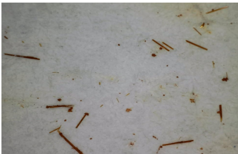
Slika 16. Mikroskopska fotografija jediničnih kristala spoja [\text{CoC}_2\text{O}_4(\text{NH}_3)_4]_6[\text{V}_{10}\text{O}_{28}] \sim 16 \text{H}_2\text{O} .
