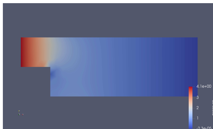
Slika 3.5: Optjecanje stepenice — tlak
