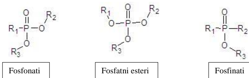
Slika 1 Strukturne formule organofosfornih spojeva koji se koriste kao sredstva za gašenje požara
