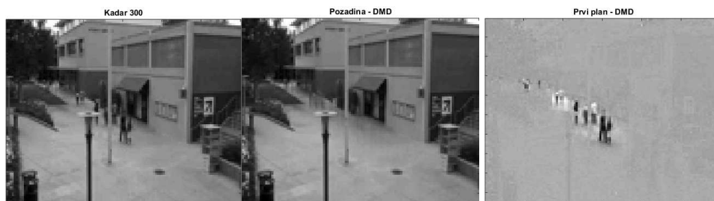
Slika 4.6: Na gornjim slikama prikazan je kadar broj 300 u videu i njegova separacija na pozadinu i prvi plan dobivena DMD algoritmom
