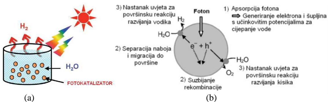
Slika 22. Shematski prikaz: (a) Dobivanja vodika pomoću sunčeve energije uz korištenje oksidnog fotokatalizatora; (b) Osnovni procesi koji se odvijaju tijekom fotokatalitičkog cijepanja vode.<sup>67</sup>
