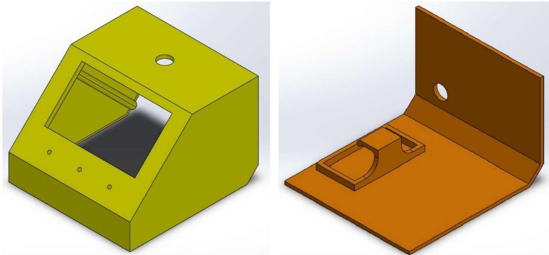
Slika 27 3D modeli dijelova kućišta (baza-lijevo, poklopac-desno)
