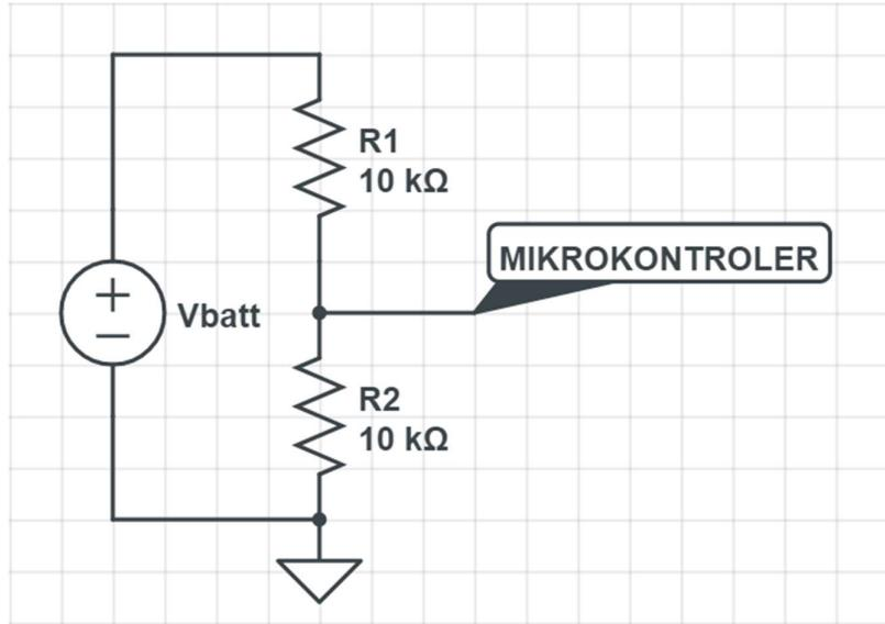
Slika 12 Shematski prikaz modula za skaliranje napona baterije
