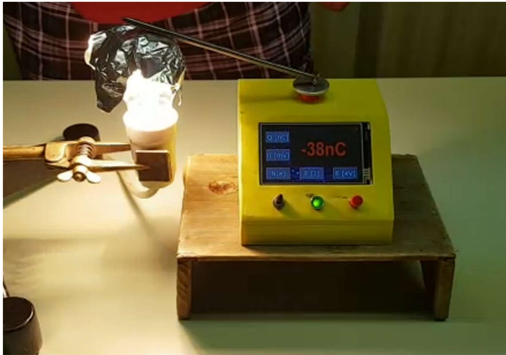
Slika 41 Postav pokusa "Termoelektronska emisija"
