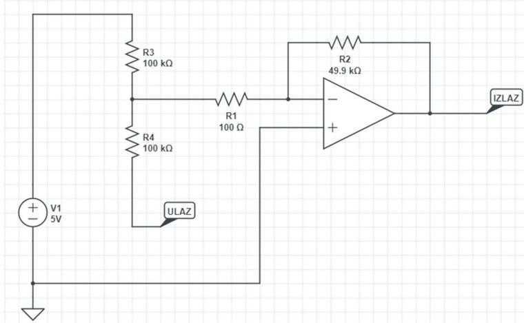
Slika 16 Shematski prikaz invertirajućeg pojačala s omskim zbrajalom
