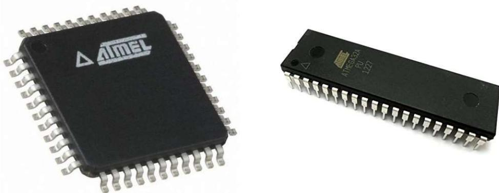
Slika 6 a) ATmega32-QFP44 (lijevo); b) ATmega32-DIP40 (desno)
