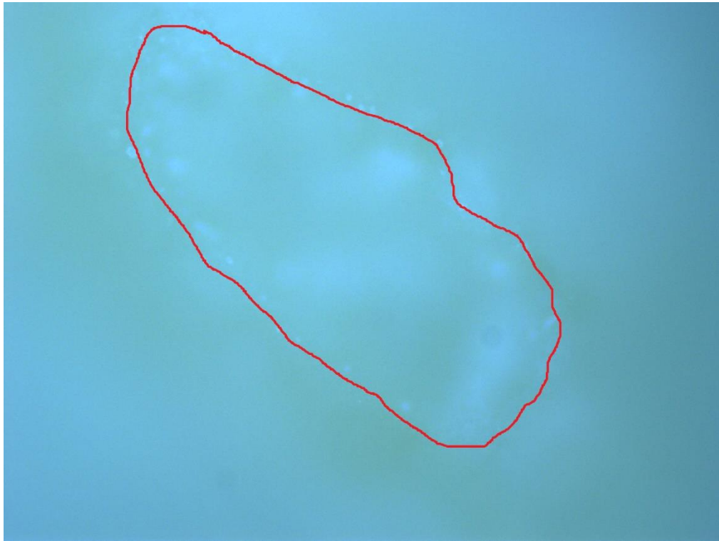
Slika 12.2. Krater na dubini od 630 \mu\text{m}
