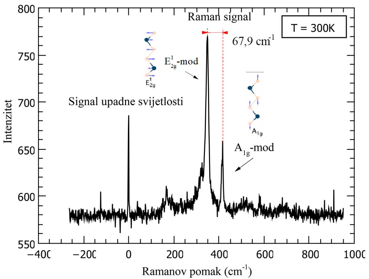
Slika 3.8: Raman spektroskopska slika WS<sub>2</sub> snimljena na valnoj duljini pobuđenja  $\lambda_e = 544\text{nm}$ . Spektar pokazuje nekoliko dobro definiranih maksimuma koji odgovaraju potpisu WS<sub>2</sub> iz literature (Slika 3.9). Maksimumi se nalaze na  $348,6\text{ cm}^{-1}$  ( $E_{2g}^1$  mod titranja) i  $416,5\text{ cm}^{-1}$  ( $A_{1g}$  mod titranja).
