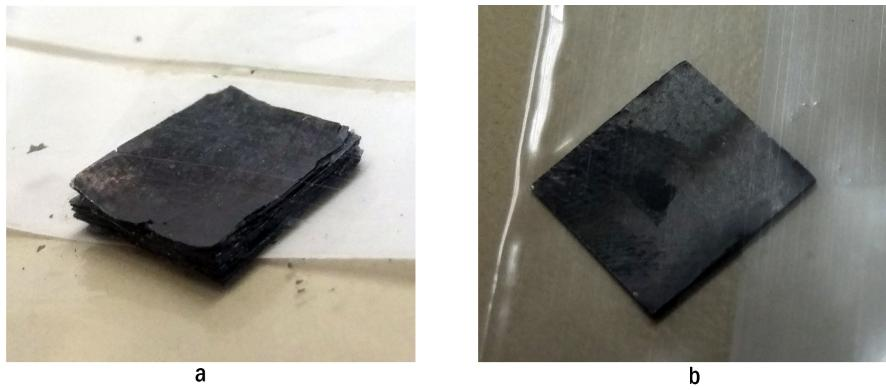
Slika 2.1: Na slici su uzorci sintetizirani za analizu skenirajućim elektronskim mikroskopom. a) Na slici je uzorak s  $\text{MoS}_2$  na površini molibdena, međutim, vidljivo je da je izreagirano previše materijala te je bilo potrebno smanjiti množinu sumpora. b) Na slici je uzorak s kristalima  $\text{WS}_2$  na površini volframa.
