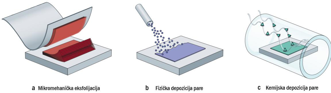
Slika 1.3: Na slici su shematski prikazi tri različite metode dobivanja 2D materijala. Slika a) prikazuje mikromehaničku eksfolijaciju, ili metodu pomoću samoljepljive trake, slika b) prikazuje fizičku depoziciju pare, a slika c) prikazuje kemijsku depoziciju pare. [9]
