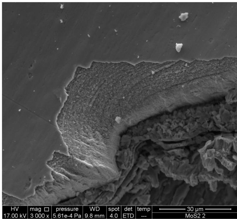
Slika 3.3: Slika MoS<sub>2</sub> dobivena elektronskom mikroskopijom. Iz slike se vidi da je dobiveni materijal slojevit i da se lako kala, što se i očekuje zbog njegove kvazi-2D prirode, odnosno Van der Waalsove interakcije između susjednih MoS<sub>2</sub> molekulske slojeva.
