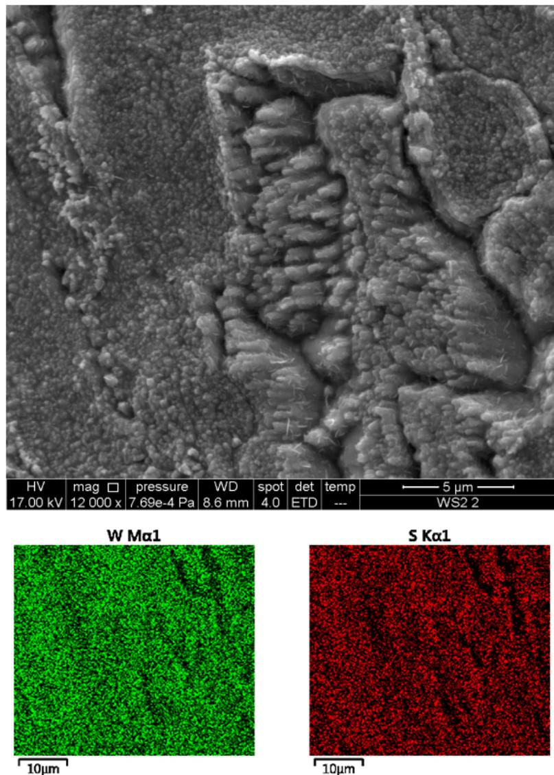
Slika 3.5: Slika morfologije  $WS_2$  s prostornom raspodjelom elemenata volframa i sumpora. Iz slike se vidi da su elementi homogeno raspoređeni, odnosno da nije došlo do precipitacije (izlučivanja) pojedinih elemenata unutar strukture, što bi se inače očitovalo u nakupinama veće gustoće.
