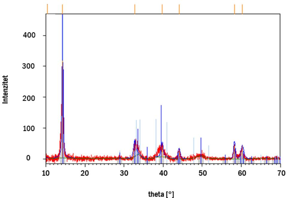
Slika 3.2: Difrakcijska slika za WS<sub>2</sub>. Slika pokazuje dobro slaganje naših mjerena (crveno) s referentnim podacima (plavo) što se vidi iz poklapanja maksimuma i referentnih oznaka prikazanih narančastom bojom preuzetih iz HighScore programskega paketa. Na oko 35° i 40° postoje dodatni signali koji pokazuju da uspješnost reakcije prilikom sinteze materijala nije stopostotna i da vjerojatno postoji još neizreagirani volfram.
