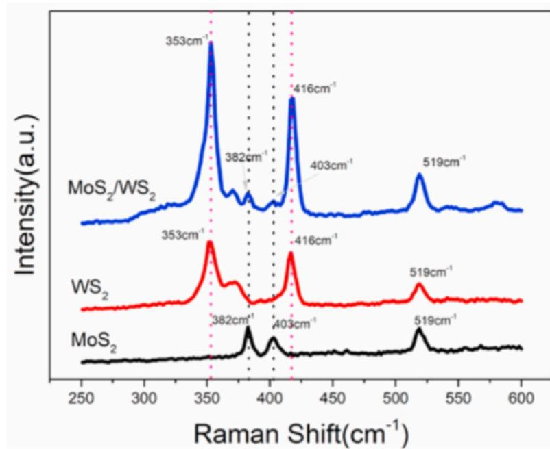
Slika 3.9: Na slici su prikazani rezultati Ramanove spektroskopije  $\text{MoS}_2$  i  $\text{WS}_2$  iz reference [23]. Usporedbom s našim mjeranjima vidljivo je da postoji poklapanje maksimuma.
