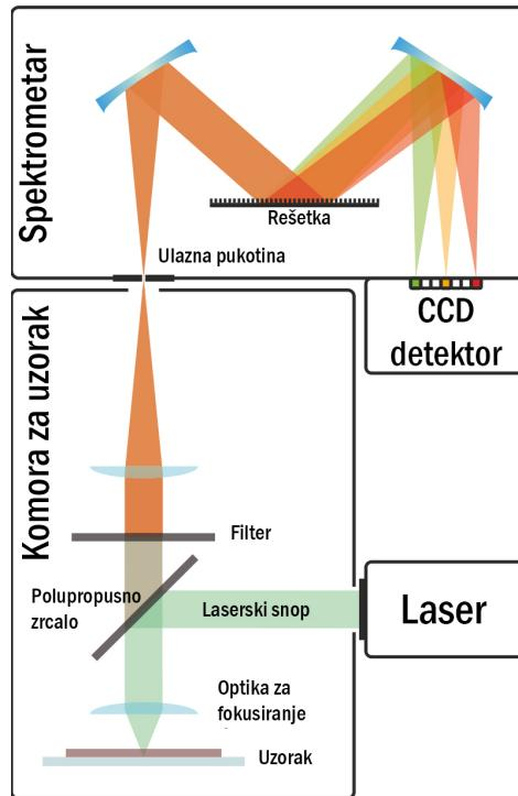
Slika 2.6: Shematski prikaz uređaja za Ramanovu spektroskopiju. Laserski snop upada na polupropusno zrcalo te se dio snopa odvodi na uzorka, a drugi dio snopa se bilježi kao referentni signal. Reflektirana svjetlost od površine uzorka odlazi na optičku rešetku, gdje se vrši separacija svjetlosti po valnim duljinama. Iz specifičnog uzorka frekvencija možemo odrediti o kojem se materijalu radi. [17]
