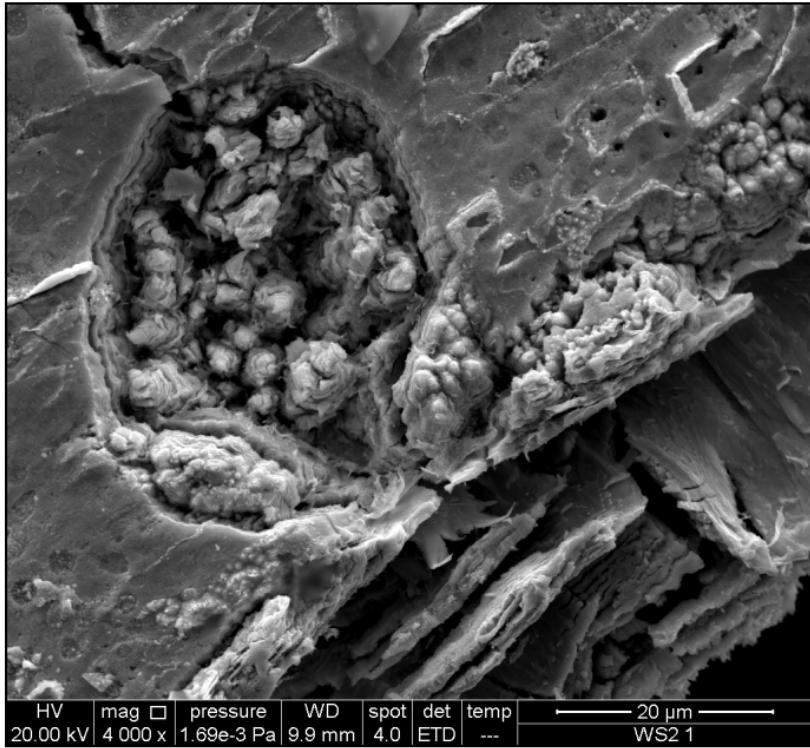
Slika 3.4: Slika WS<sub>2</sub> dobivena elektronskom mikroskopijom. Kao i u slučaju MoS<sub>2</sub>, iz slike se vidi da je dobiveni materijal slojevit i da se lako kala, što se i očekuje zbog njegove kvazi-2D prirode.
