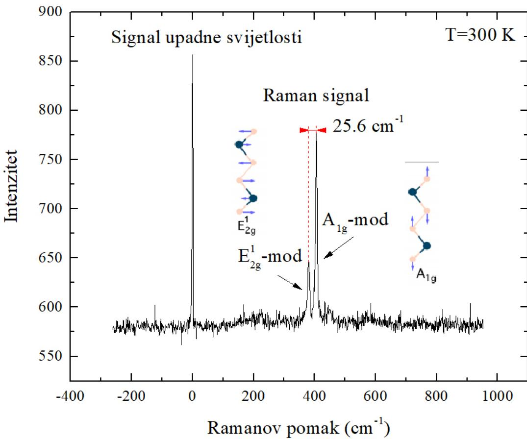
Slika 3.7: Raman spektroskopska slika  $MoS_2$  snimljena na valnoj duljini pobuđenja  $\lambda_e = 544\text{nm}$ , što odgovara zelenoj svjetlosti. Spektar pokazuje nekoliko dobro definiranih maksimuma, koji odgovaraju potpisu  $MoS_2$  iz literature (Slika 3.9). Maksimumi se nalaze na Ramanovom pomaku  $380,8\text{ cm}^{-1}$  ( $E^{1}_{2g}$  mod titranja) i  $406,4\text{ cm}^{-1}$  ( $A_{1g}$  mod titranja).
