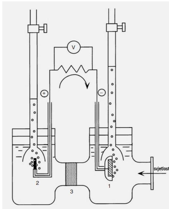
Slika 1.2: Shematski prikaz eksperimentalnog postava za proizvodnju vodika fotoelektrolizom. Fotoelektroda (1) napravljena je od titanovog oksida ( $\text{TiO}_2$ ), kontra-elektroda (2) je napravljena od platine, a polupropusna membrana (3) omogućava izmjenu iona, ali ne i miješanje nastalih plinova. [8]
