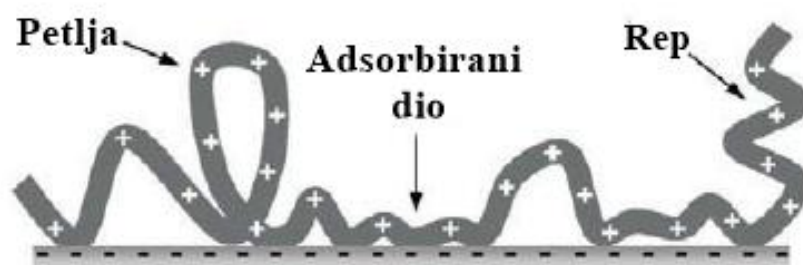
Slika 7. Adsorpcija polielektrolitnog lanca na površinu supstrata (preuzeto i prilagođeno iz ref. 1)
