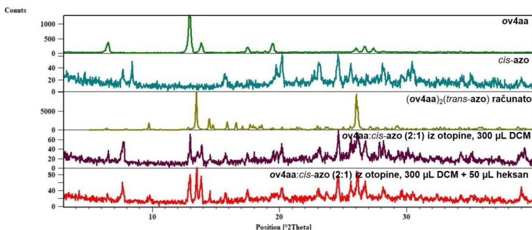
**Slika 49.** Usporedba difraktograma produkata dobivenih kokristalizacijom **ov4aa** s **cis-azo** u otopini s računatim difraktogramom kokristala **(ov4aa)<sub>2</sub>(trans-azo)** i difraktogramima reaktanata
