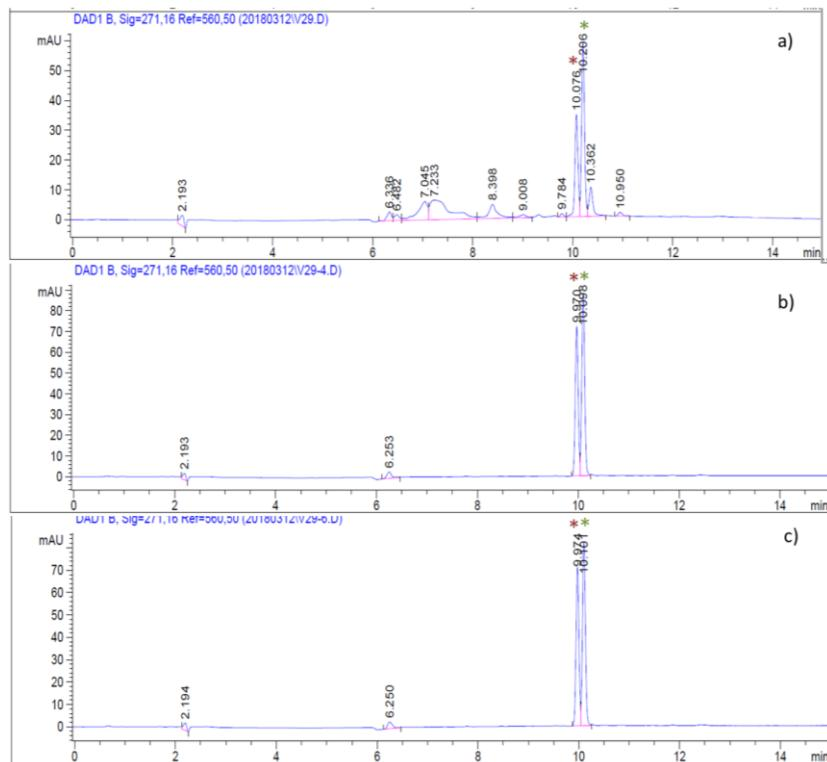
**Slika D3.** Usporedba kromatograma dobivenih analizom otopine a) prije i nakon provedene izomerizacije u trajanju od b) 1 minute i c) 7 minuta uz elektromagnetsko zračenje valne duljine raspona 400-800 nm; (\*) označava signal za **itfa**, \* **cis-azo**, a \* **trans-azo**)
