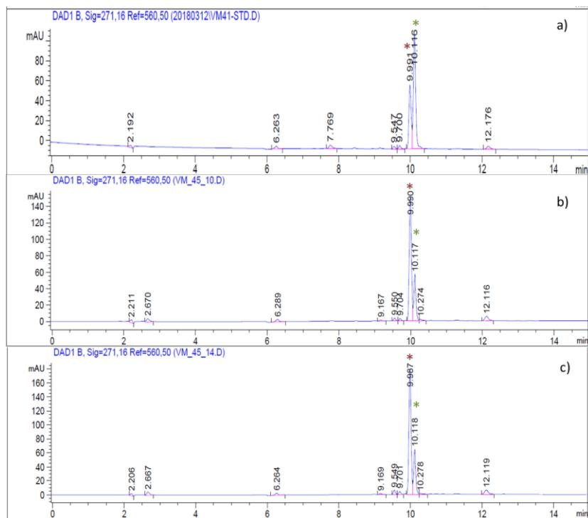
**Slika 44.** Usporedba kromatograma dobivenih analizom otopine *trans*-**azo** a) prije i b) nakon izomerizacije u trajanju od 10 minuta, te c) nakon 14 minuta; (\*) označava signal za itfa, \* *cis*-**azo**, a \* *trans*-**azo**)
