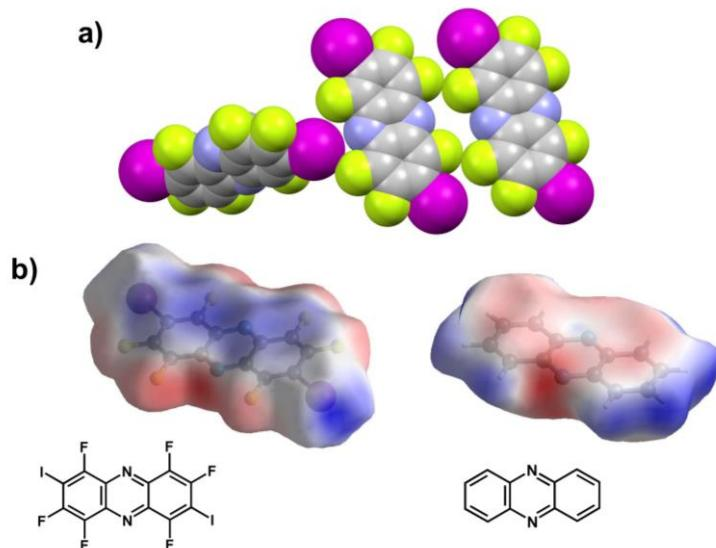
Slika 52. a) Prikaz povezivanja molekula **fzn** u kristalnoj strukturi, b) molekulski elektrostatski potencijal (izračunat na HF/3-21G razini teorije) mapiran na Hirshfeldovu površinu molekule **fzn** (raspon boja: crvena  $-0,068 \text{ a.u.}$ ; plava =  $0,068 \text{ a.u.}$ ) i molekule fenazina (raspon boja: crvena  $-0,061 \text{ a.u.}$ ; plava =  $0,069 \text{ a.u.}$ )
