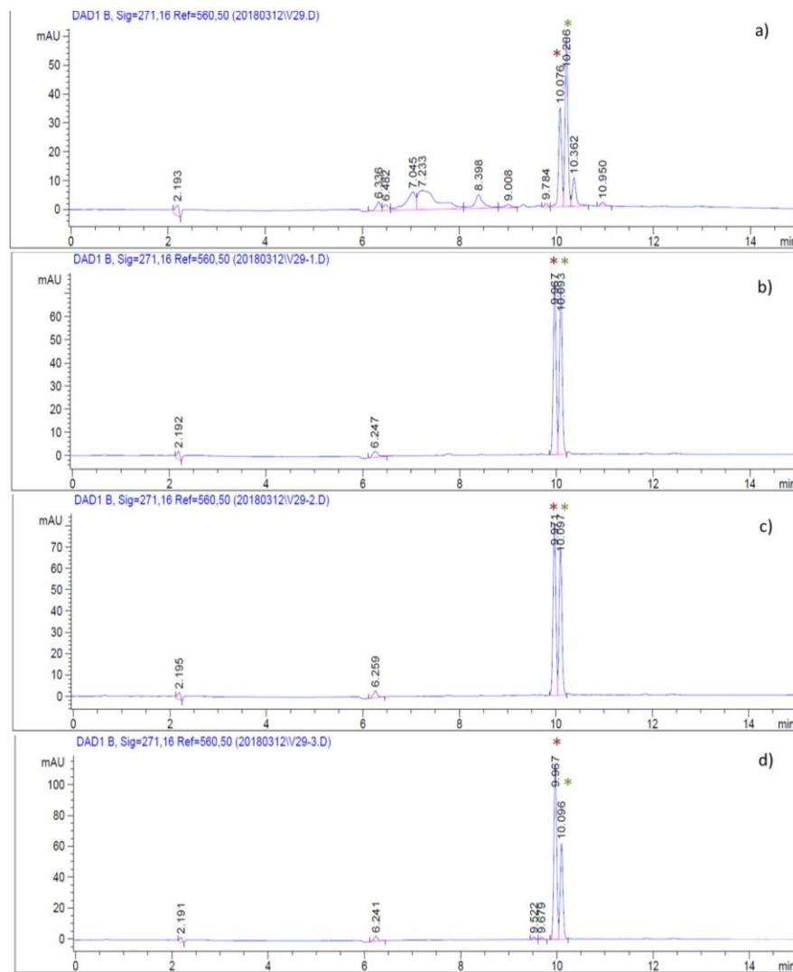
**Slika D1.** Usporedba kromatograma dobivenih analizom otopine a) prije, te nakon provedene izomerizacije u trajanju od b) 1, c) 2 i d) 7 minuta uz elektromagnetsko zračenje od 350 nm; (\*) označava signal za **itfa**, \*\* *cis-azo*, a \*\*\* *trans-azo*)
