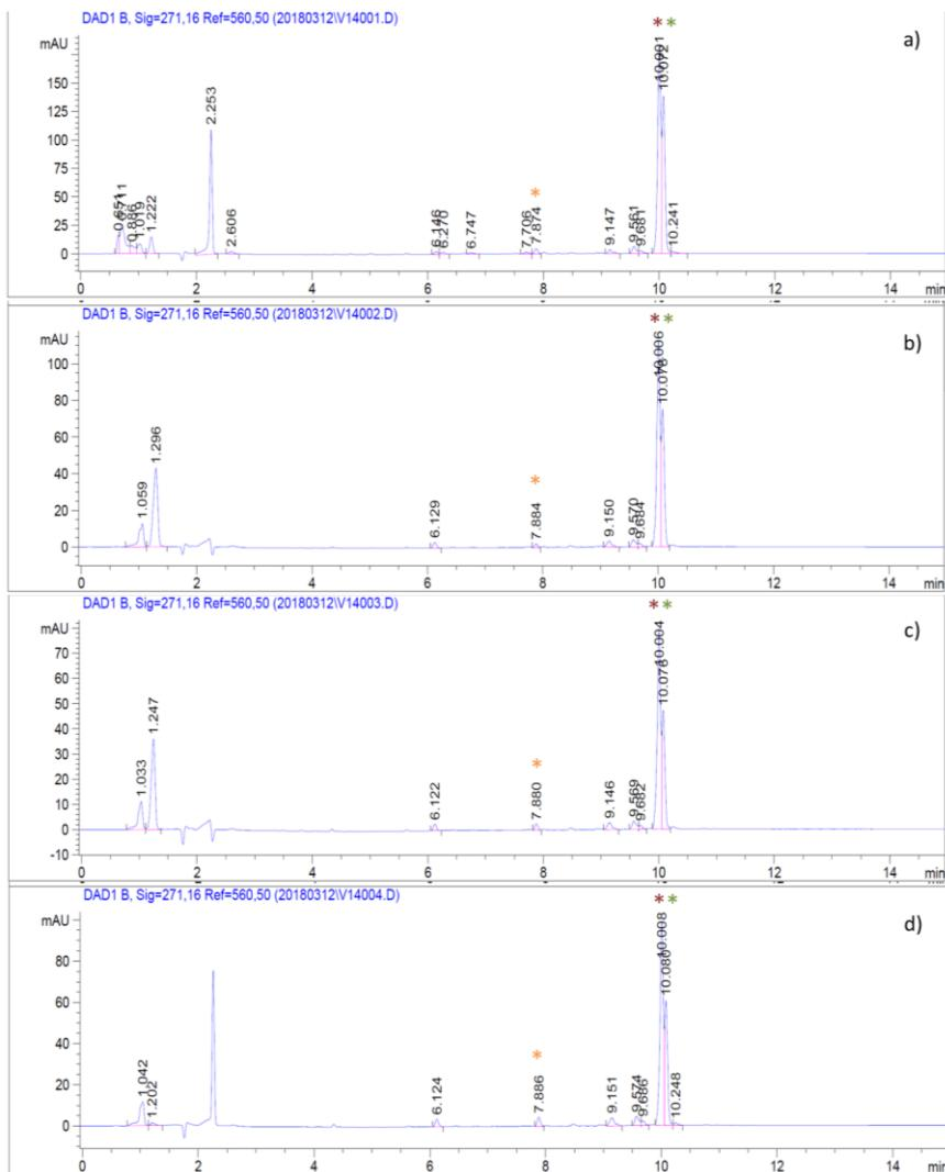
**Slika 41.** Prikaz kromatograma produkata mljevenja nakon a) 1, b) 2, c) 3 ili d) 4 sata provođenja reakcije mehanokemijske sinteze *cis*- i *trans*-**azo** uz KMnO<sub>4</sub>, u omjeru 1:6 i uz 200 mg Al<sub>2</sub>O<sub>3</sub> te uz dodatak 80 µL acetona; (\*) označava signal za **itfa**, \* *cis*-**azo**, a \* *trans*-**azo**)
