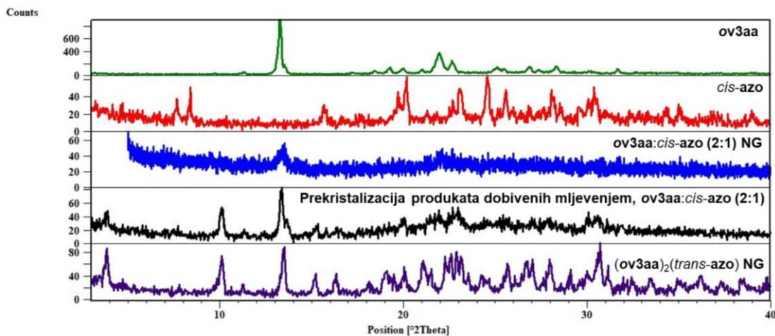
**Slika 47.** Usporedba difraktograma produkata dobivenog mljevenjem **ov3aa:cis-azo** u množinskom omjeru 2:1 i difraktograma dobivenog prekristalizacijom produkta mljevenja s difraktogramima rektanata te kokristala  $(ov3aa)_2(trans\text{-}azo)$
