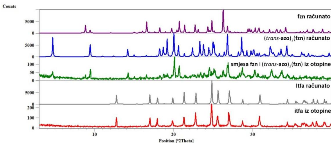
Slika 34. Usporedba difraktograma smjese fzn i  $(\text{trans-azo})_2(\text{fzn})$ , difraktograma spoja **itfa** dobivenih sintezom iz otopine s pripadajućim računatim difraktogramima
