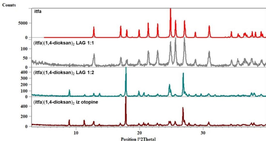
**Slika 33.** Prikaz računatog diftaktograma **itfa**, difraktograma (**itfa**)(1,4-dioksan)<sub>2</sub> dobivenog mehanokemijskom sintezom u stehiometrijskim omjerima 1:1 i 1:2 te difraktograma nusprodukta (**itfa**)(1,4-dioksan)<sub>2</sub> dobivenog iz otopine
