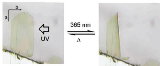
Slika 20. Savijanje tankih pločica aminoazobenzena pod utjecajem elektromagnetskog zračenja.<sup>69</sup>
