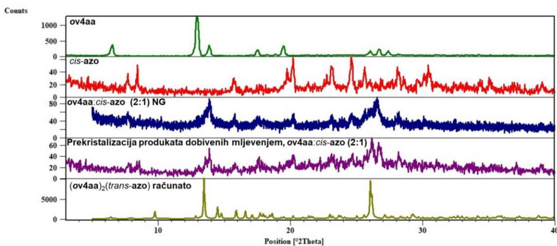
**Slika 48.** Usporedba difraktograma produkata dobivenih mljevenjem **ov4aa:cis-azo** u množinskom omjeru 2:1, difraktograma dobivenog prekristalizacijom produkta mljevenja s difraktogramima rektanata te računatog difraktograma kokristala  $(ov4aa)_2(trans\text{-}azo)$
