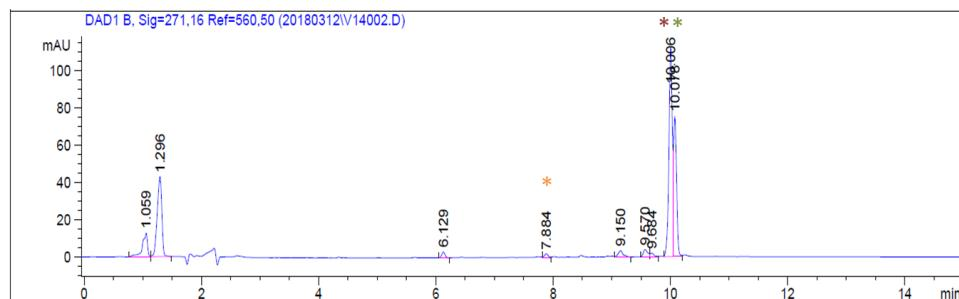
**Slika 42.** Kromatogram mehanokemijske sinteze *cis*- i *trans*-**azo** uz najpovoljnije uvjete, nakon 2 h mljevenja uz KMnO<sub>4</sub>, u omjeru 1:6 i uz 200 mg Al<sub>2</sub>O<sub>3</sub> te dodatak 80 μL acetona; (\*) označava signal za **itfa**, (\*) *cis*-**azo**, a (\*) *trans*-**azo**
