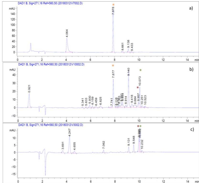
**Slika 37.** Prikaz kromatograma produkata mehanokemijske sinteze *cis*- i *trans*-azo provedene uz različiti oksidans a) PCC, b) CrO<sub>3</sub> i c) KMnO<sub>4</sub> (\* označava signal za **itfa**, \* *cis*-azo, a \* *trans*-azo)
