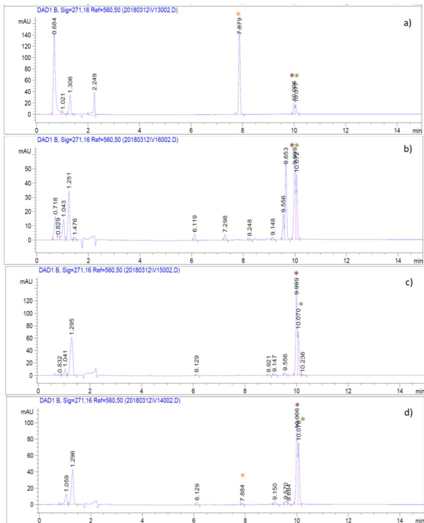
**Slika 40.** Usporedba kromatograma produkata mehanokemijske sinteze *cis*- i *trans*-**azo** dobivenih uz dodatak tekućine; a) vode, b) benzena, c) acetonitrila i d) acetona; (\*) označava signal za **itfa**, \*\* cis-**azo**, a \*\*\* trans-**azo**)
