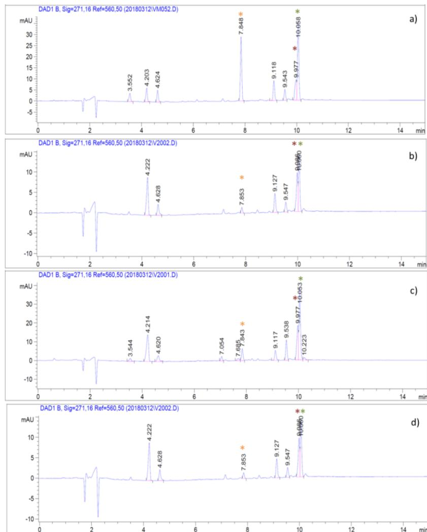
**Slika 38.** Usporedba kromatograma produkata mehanokemijske sinteze *cis*- i *trans*-**azo** provedenih uz različite omjere **itfa** i  $\text{KMnO}_4$ , a) 1:2 b) 1:4 c) 1:5 d) 1:6; (\*) označava signal za **itfa**, \* *cis*-**azo**, a \* *trans*-**azo**
