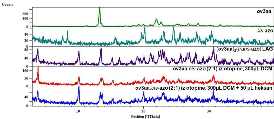
**Slika 50.** Usporedba difraktograma produkata dobivenih kokristalizacijom **ov3aa** s **cis-azo** u otopini s difraktogramom kokristala  $(\text{ov3aa})_2(\text{trans-azo})$  i difraktogramima reaktanata
