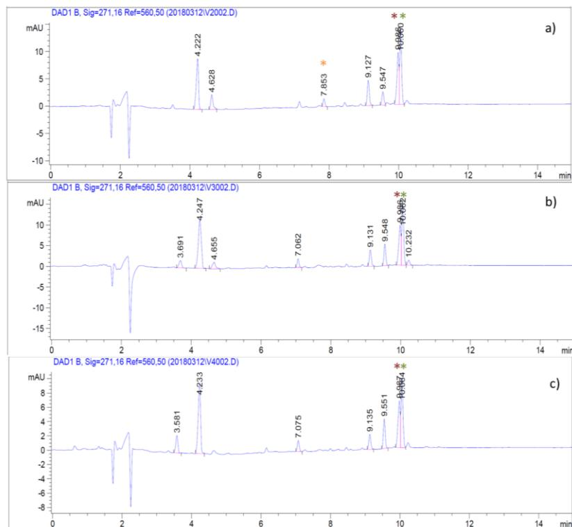
**Slika 39.** Usporedba kromatograma produkata mehanokemijske sinteze *cis*- i *trans*-**azo** dobivenih uz različitu količinu  $\text{Al}_2\text{O}_3$  a) 100 mg b) 200 mg c) 300 mg; (\*) označava signal za **itfa**, \* *cis*-**azo**, a \* *trans*-**azo**
