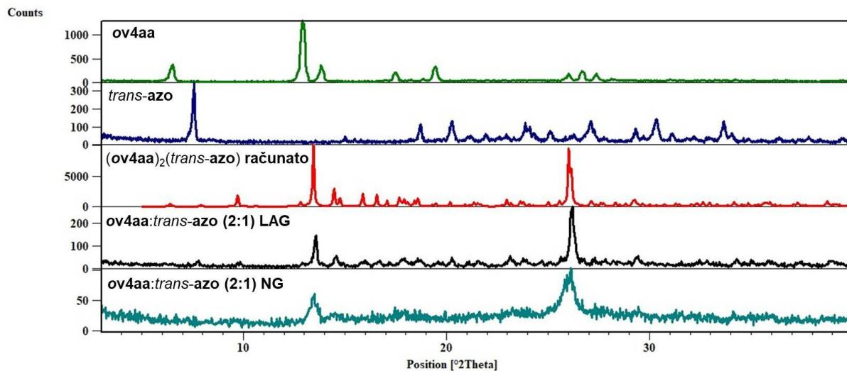
**Slika 46.** Usporedba difraktograma dobivenih mljevenjem **ov4aa:trans-azo** u omjeru 2:1 metodama NG i LAG s računatim difraktogramom kokristala **(ov4aa)<sub>2</sub>(trans-azo)** i difraktogramima reaktanata
