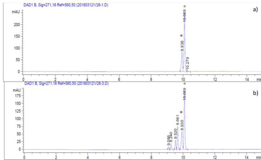
**Slika D2.** Usporedba kromatograma dobivenih analizom otopine a) prije i b) nakon provedene izomerizacije u trajanju od 2 minute uz elektromagnetsko zračenje valne duljine 300 nm; (\* označava signal za **iffa**, \* *cis*-**azo**, a \* *trans*-**azo**)
