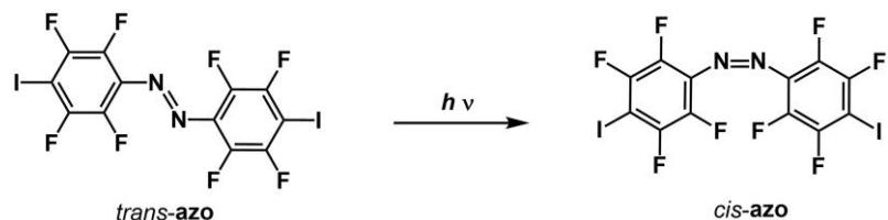
**Slika 31.** Shema izomerizacije**3.2.2. Priprava kokristala****3.2.2.1. Sinteza iminâ**
