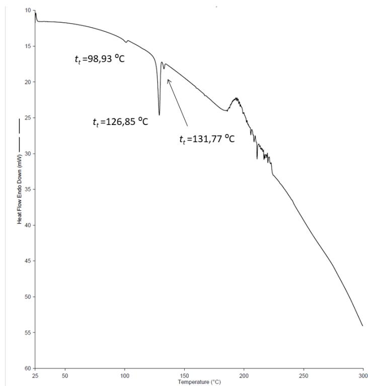
Slika D8. DSC krivulja kokristala  $(\text{ov3aa})_2(\text{trans-azo})$
