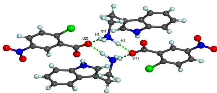
**Slika 5.** Prikaz povezivanja ionskih parova vodikovim vezama u kristalnoj strukturi spoja A. Dva kationa i dva aniona čine tetramer povezan vodikovim vezama N11–H1···O21 i N11–H3···O21<sup>i</sup>. Atomi su prikazani kao kuglice proizvoljnih radijusa standardnih boja [kisik – crveno, ugljik – crno (sivo), dušik – plavo, klor – zeleno i vodik – bijelo (tirkizno)]. Crtež je napravljen pomoću programa *Mercury* 2.3.<sup>[31]</sup>, *RasTOP*<sup>[32]</sup> i *POV-Ray*<sup>[33]</sup>.
