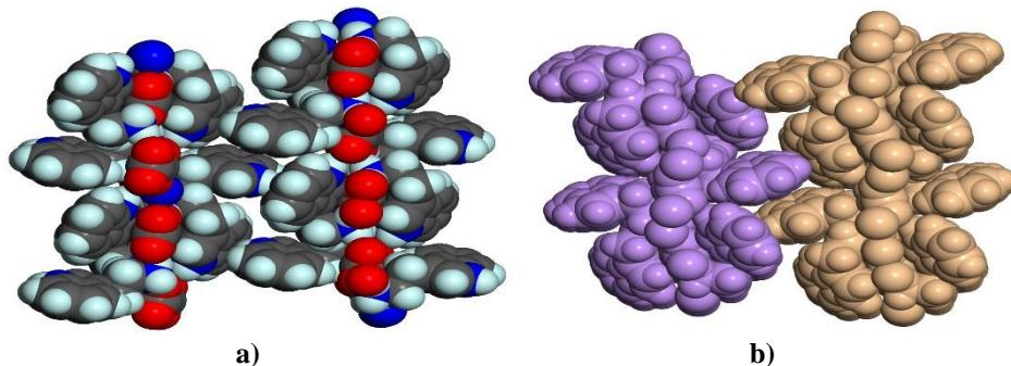
**Slika 15.** Prikaz naslagivanja molekulskih slojeva u kristalnoj strukturi spoja C. a) Atomi su prikazani kao kuglice van der Waalsovog radijusa standardnih boja [ugljik – crno (sivo), dušik – plavo, kisik – crveno i vodik – bijelo (tirkizno)]. b) Atomi jednog sloja obojani su ljubičasto, a atomi drugog sloja bež. Crteži su napravljeni pomoću programa Mercury 2.3.<sup>[31]</sup>, RasTOP<sup>[32]</sup> i POV-Ray<sup>[33]</sup>.
