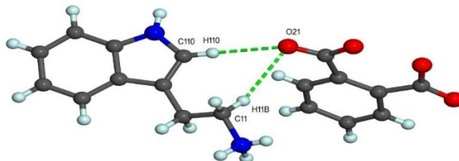
**Slika 11.** Prikaz C–H···O vodikovih veza u kristalnoj strukturi spoja **B** koje dodatno učvršćuju molekulske slojeve. Atomi su prikazani kao kuglice proizvoljnog radijusa standardnih boja [kisik – crveno, ugljik – crno (sivo), dušik – plavo i vodik – bijelo (tirkizno)]. Crtež je napravljen pomoću programa *Mercury 2.3*<sup>[31]</sup>, *RasTOP*<sup>[32]</sup> i *POV-Ray*<sup>[33]</sup>.
