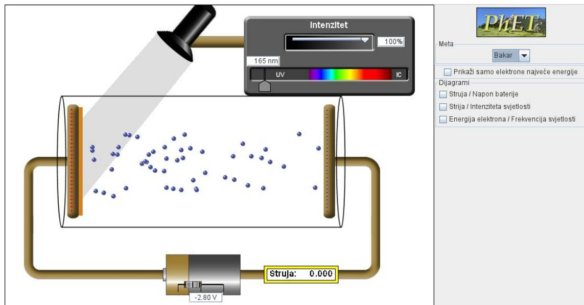
Slika 2.36. Zaustavni potencijal i fotoelektrični efekt za bakar.
