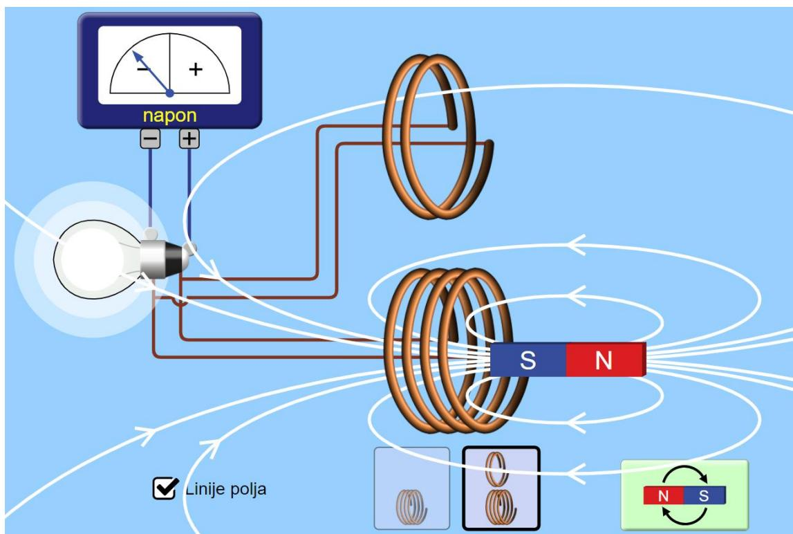
Slika 2.29. Elektromagnetska indukcija.
