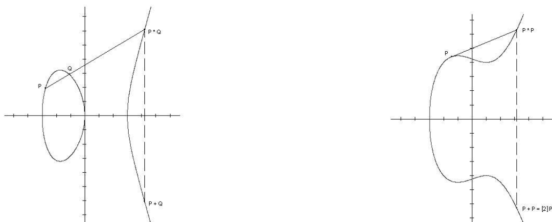
(a) Zbrajanje točaka P, Q na eliptičkoj krivulji
