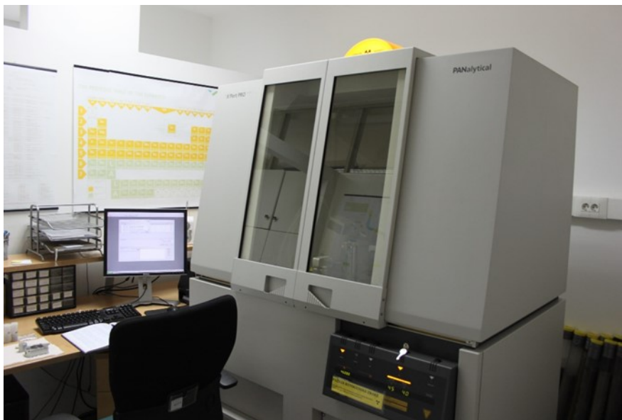
Slika 3.12. Rendgenski difraktometar PANalytical Xpert Powder, PW 3040/60. ( https://www.hgi-cgs.hr/zavod-za-geologiju-mineralosko-petrografski-laboratorij )
