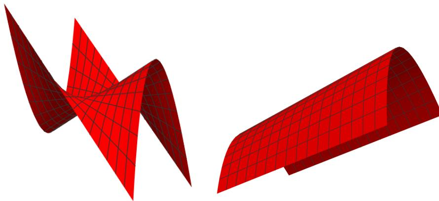
Slika 3.8: Parabolički konoid
