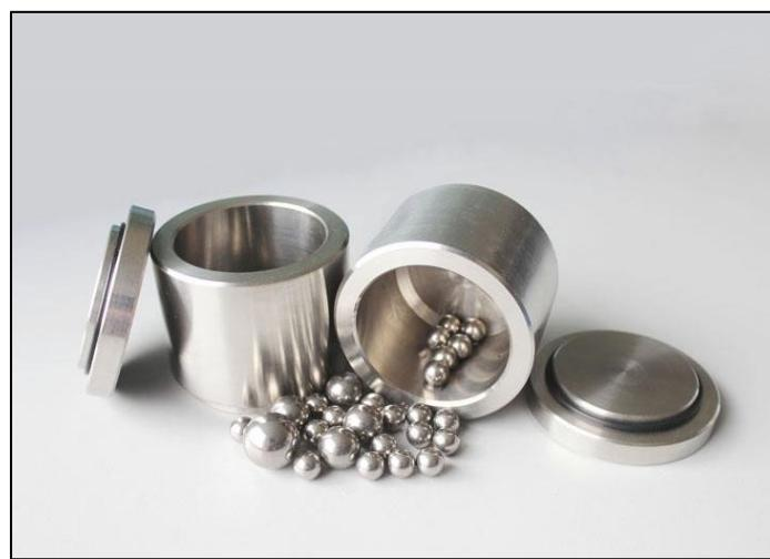
Slika 12. Posudice za mljevenje i kuglice od nehrđajućeg čelika<sup>36</sup>
