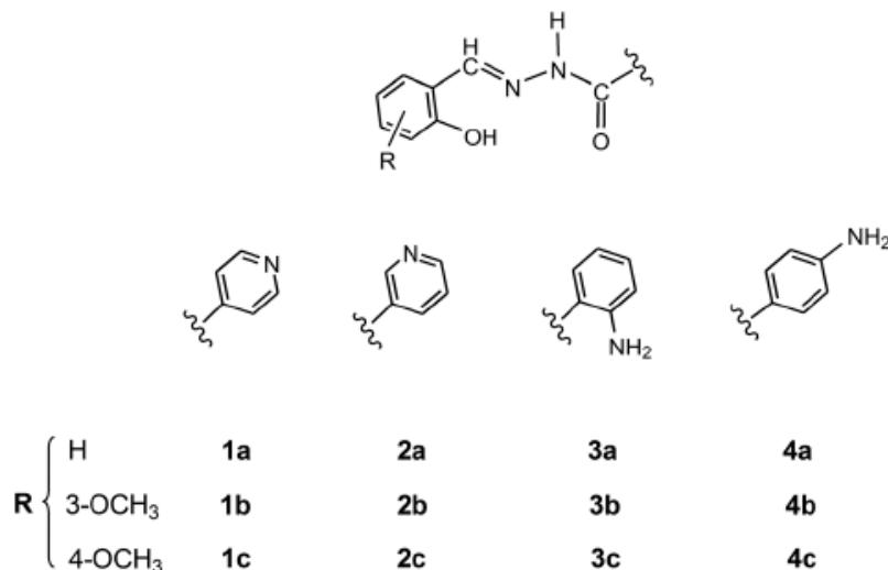
**Slika 4.** Strukture aroil-hidrazona
