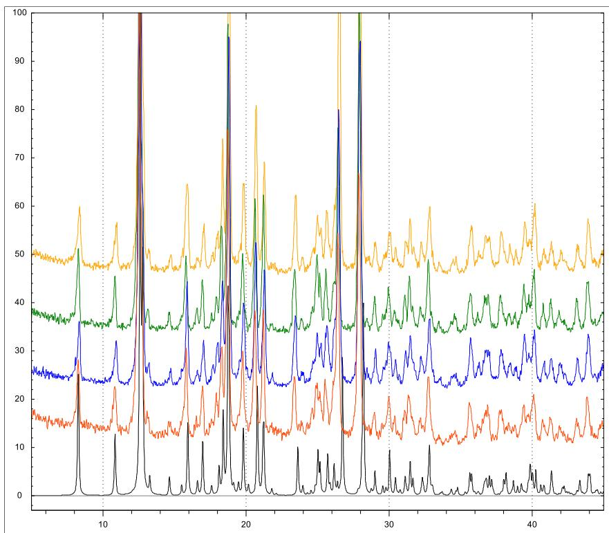
**Slika 20.** Usporedba difraktograma prahova kompleksa  $[\text{MoO}_2(3\text{OHSal}-4\text{HBOH})(\text{MeOH})]$  priređenih različitim postupcima – izračunati (crno), sinteza uz refluks (crveno), solvotermalno (plavo), prijelaz polimera u mononuklearni spoj u parama (zeleno) i prijelaz polimera u metanolu (narančasto)
