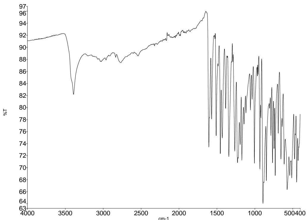
**Slika D22.** Infracrveni spektar kompleksa  $[\text{MoO}_2(\text{3OHSal-4HBOH})(\text{MeOH})]$  sintetiziranog solvotermalnom sintezom
