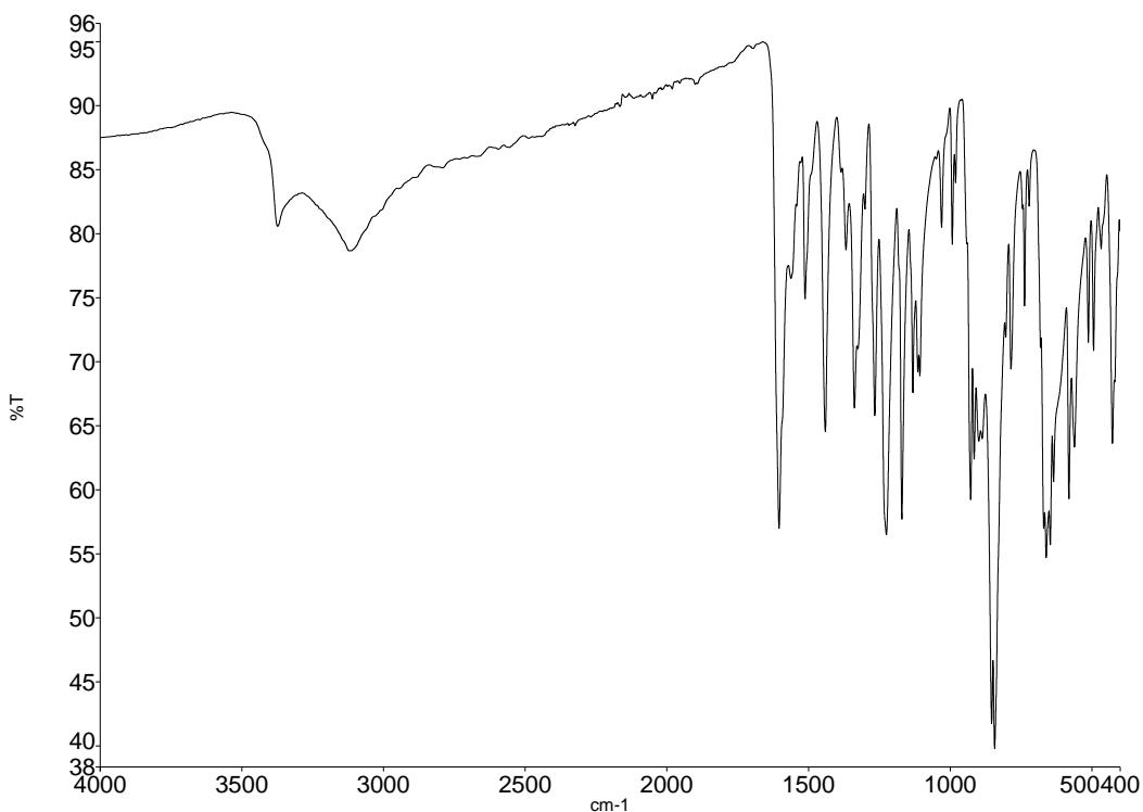
**Slika D31.** Infracrveni spektar polimera  $[\text{MoO}_2(\text{4OHSal-4HBOH})]_n$  dobivenog solvotermalnom sintezom
