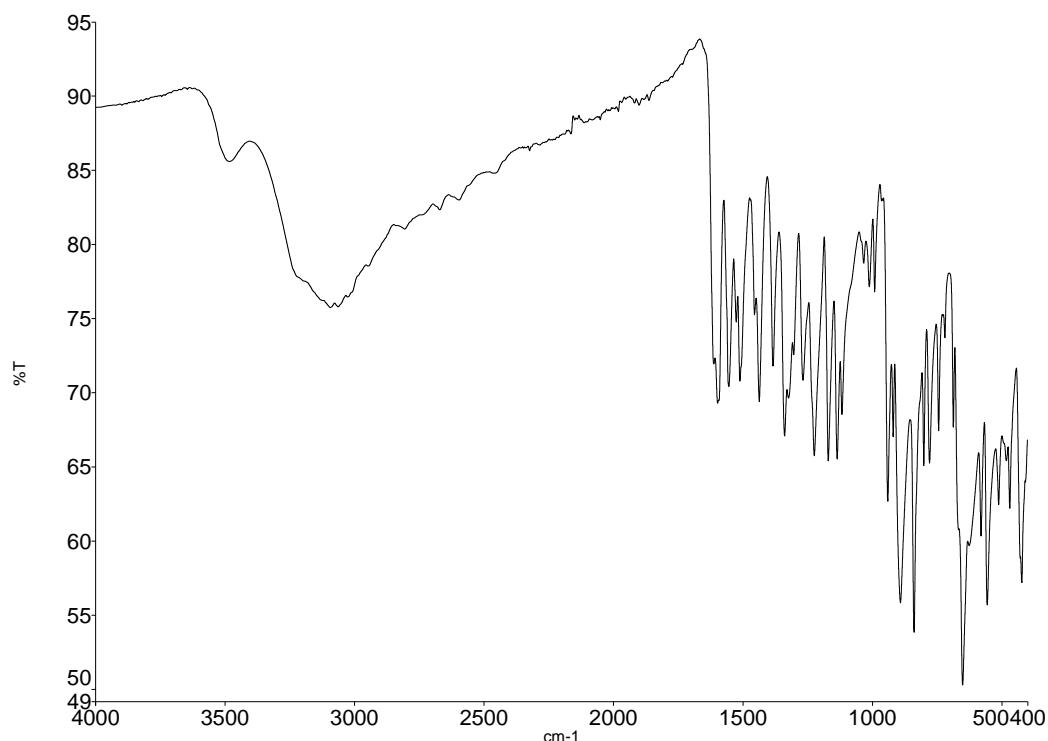
**Slika D27.** Infracrveni spektar kompleksa  $[\text{MoO}_2(\text{4OHSal-4HBOH})(\text{H}_2\text{O})]$  dobiven transformacijom polimera  $[\text{MoO}_2(\text{4OHSal-4HBOH})]_n$  u metanolu
