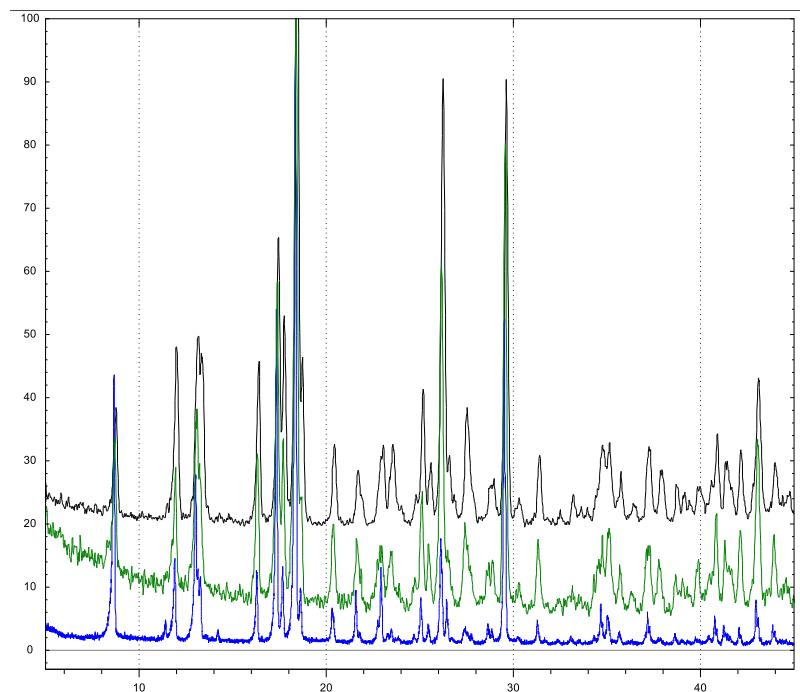
**Slika 22.** Difraktogrami prahova priređenog kompleksa  $[\text{MoO}_2(\text{4OHSal-4HBOH})(\text{EtOH})]$ : metoda B (plavo), metoda D (zeleno) i metoda A (crno)
