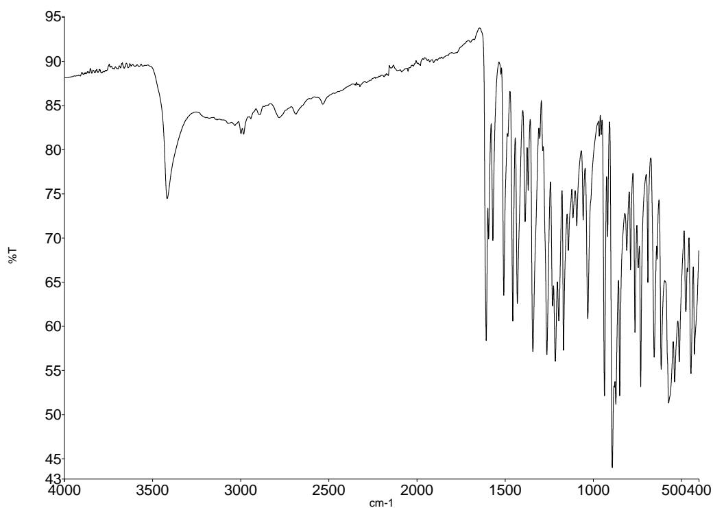
**Slika D25.** Infracrveni spektar kompleksa  $[\text{MoO}_2(\text{3OHSal-4HBOH})(\text{EtOH})]$  dobivenog transformacijom polimera u monomer pomoću para etanola
