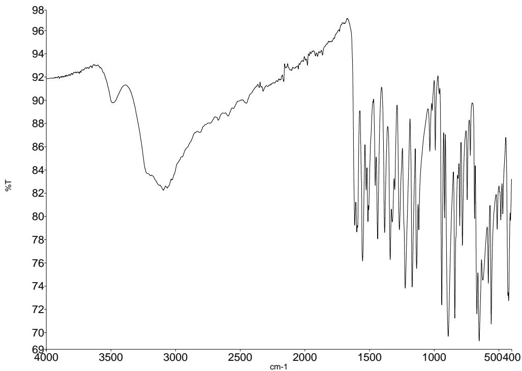
**Slika D32.** Infracrveni spektar kompleksa  $[\text{MoO}_2(\text{4OHSal-4HBOH})(\text{H}_2\text{O})]$  priređenog sintezom u acetonu uz refluks
