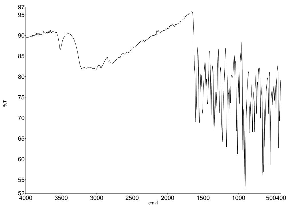
**Slika D28.** Infracrveni spektar kompleksa  $[\text{MoO}_2(\text{4OHSal-4HBOH})(\text{H}_2\text{O})]$  dobivenog transformacijom polimera  $[\text{MoO}_2(\text{4OHSal-4HBOH})]_n$  u parama metanola
