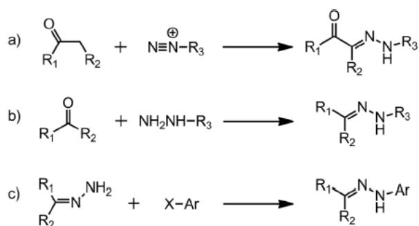
Slika 2. Sinteza hidrazona: a) Japp-Klingemannovom reakcijom, b) reakcijom hidrazina s aldehidom/ketonom, c) supstitucijom aril-halogenida i nesupstituiranih hidrazona
