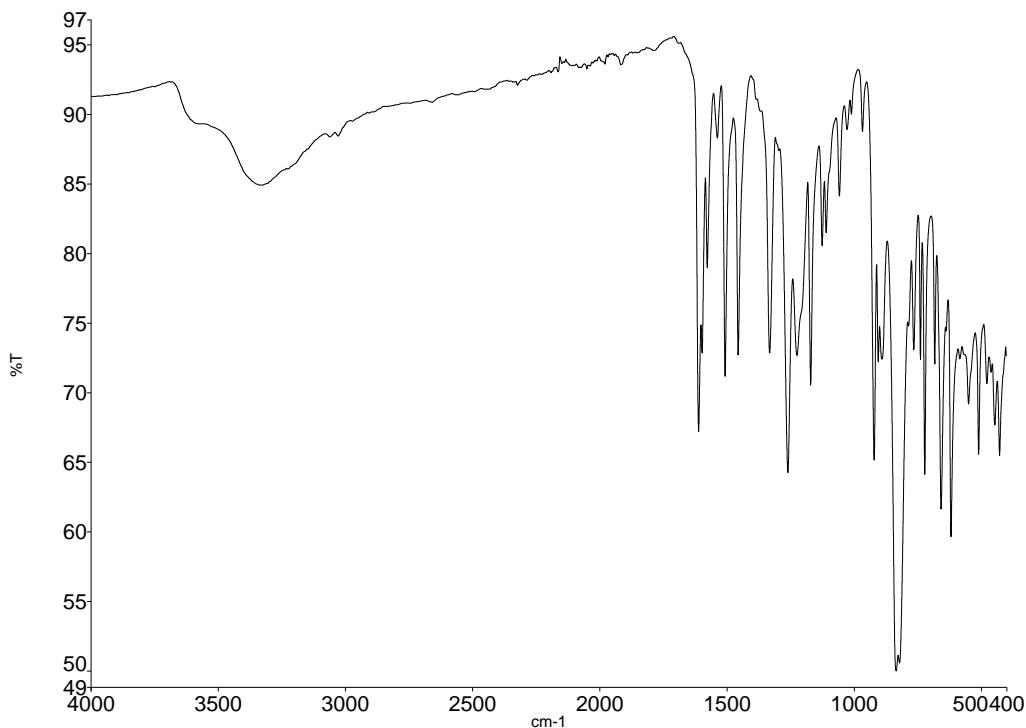
**Slika D26.** Infracrveni spektar polimernog kompleksa  $[\text{MoO}_2(\text{3OHSal-4HBOH})]_n$  dobivenog solvotermalnom sintezom
