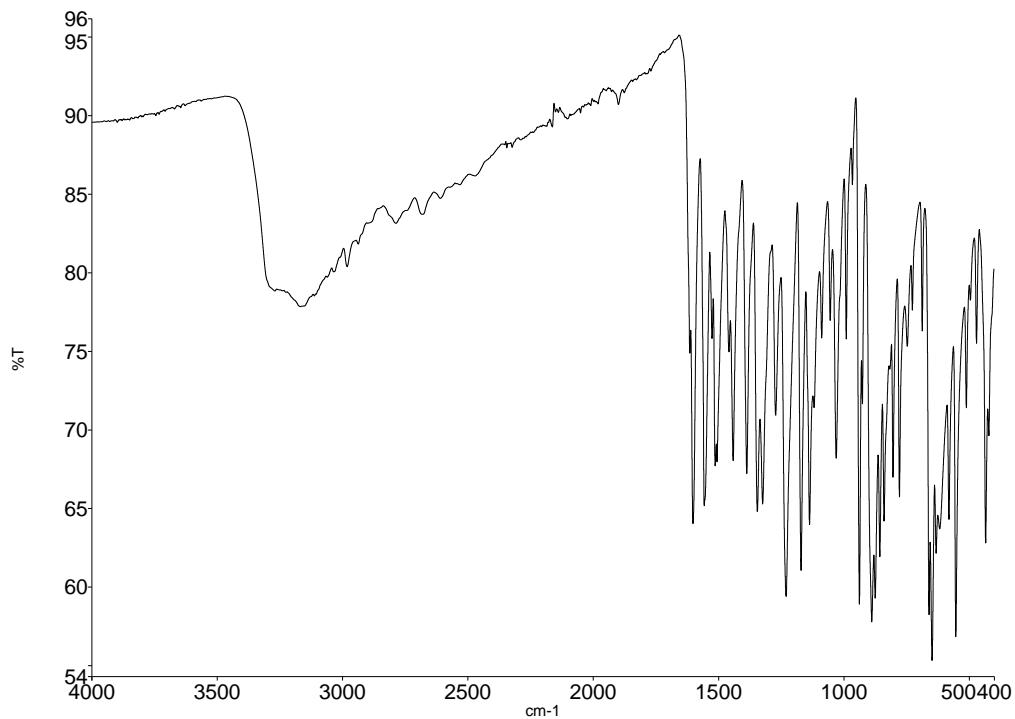
**Slika D29.** Infracrveni spektar kompleksa  $[\text{MoO}_2(\text{4OHSal-4HBOH})(\text{EtOH})]$  dobiven solvotermalnom sintezom
