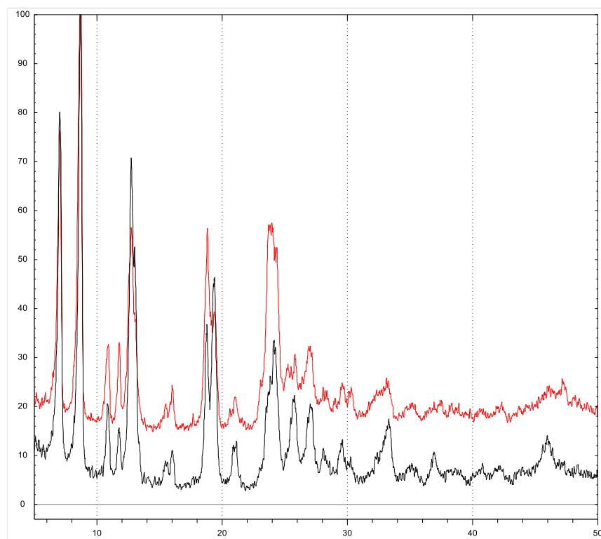
**Slika 18.** Usporedba difraktograma praha polimera  $[\text{MoO}_2(3\text{OHSal}-4\text{HBOH})]_n$ , dobivenog sintezom uz refluks (crno) i solvothermalnom sintezom (crveno)
