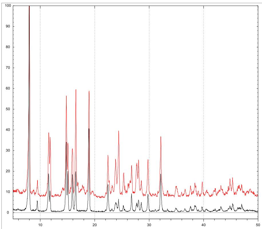
**Slika 19.** Usporedba difraktograma prahova polimernog spoja  $[MoO_2(4OHSal-4HBOH)]_n$  dobivenog sintezom uz refluks (crno) i solvotermalnom isntezom (crveno)
