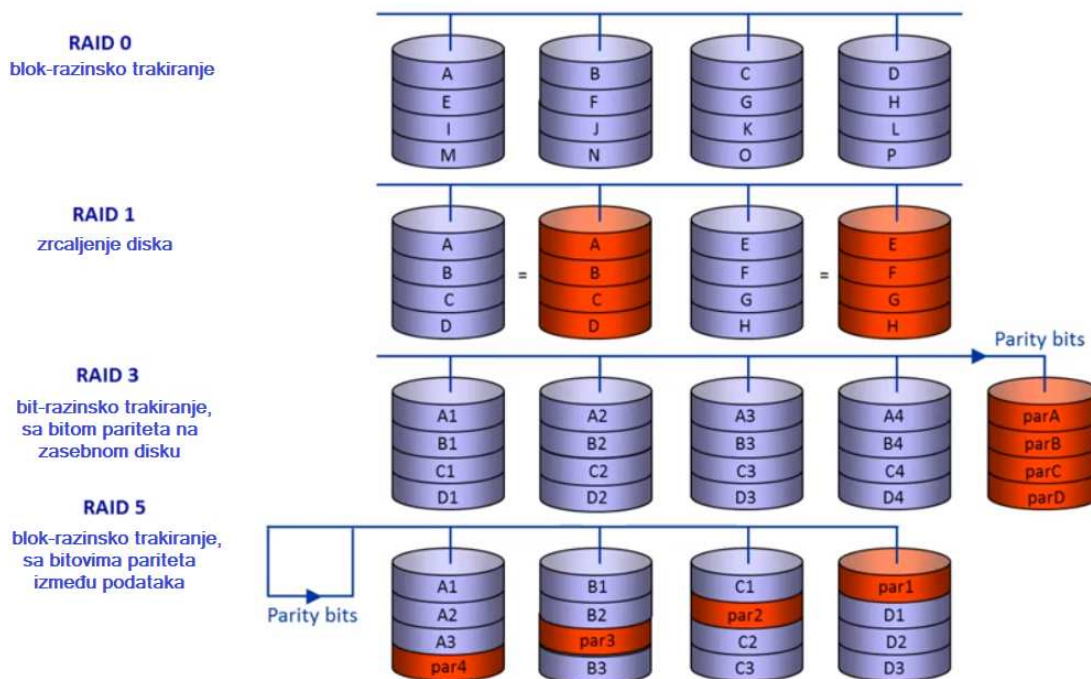
Slika 3.1: Ilustracija RAID razina 0, 1, 3 i 5
