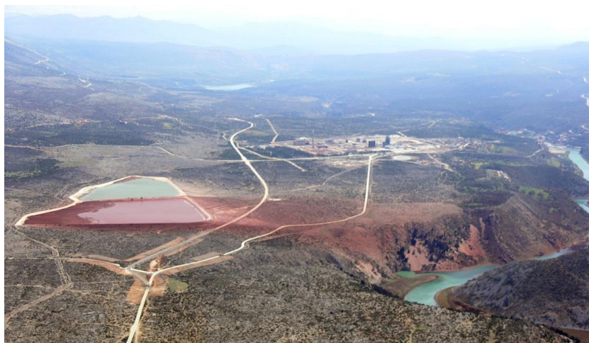
Slika 3. Prikaz prijenosa čestica crvenog mulja iz bazena tvornice glinice Jadral u tok rijeke Zrmanje 13
