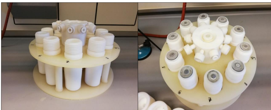
Slika 5. Teflonske posude s uzorcima boksita
