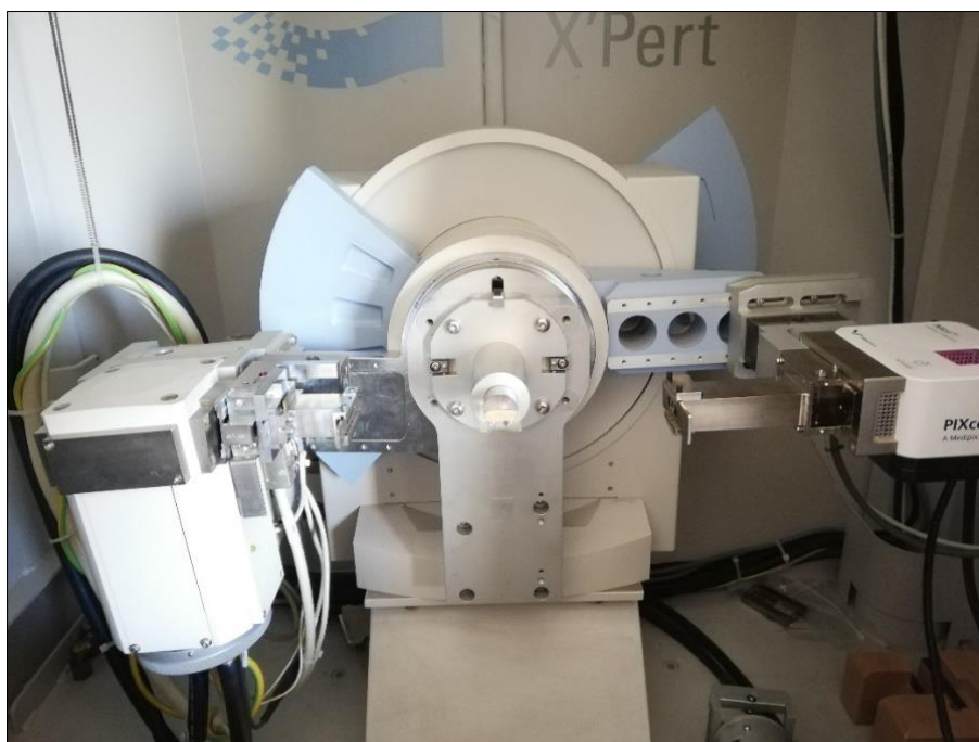
Slika 10. Difraktometar Phillips PW 3040/60 X'Pert PRO na MPZ-u PMF-a
