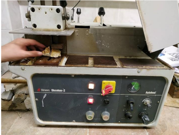
Slika 6. Rezanje uzorka na uređaju (STRUERS DISCOTOM-2) (vlastita fotografija).
