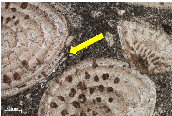
Slika 17. Mikrofotografija, Nummulites sp., dodirivanje kućica i oštećeni najmlađi zavoj.
