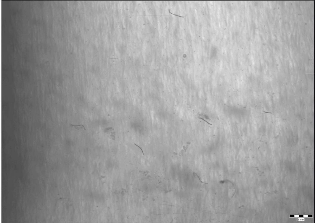
Slika 26. Uzorak jezgre i103, frakcija manja od 63 µm, gustoće manje od 1,65 g/cm<sup>3</sup>
