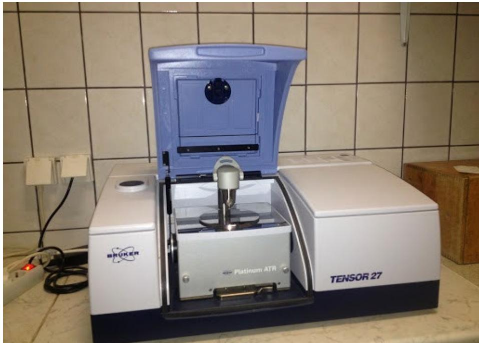
Slika 16. Tensor 27 spektrometar za snimanje FTIR spektra pripremljen za snimanje u ATR-u
