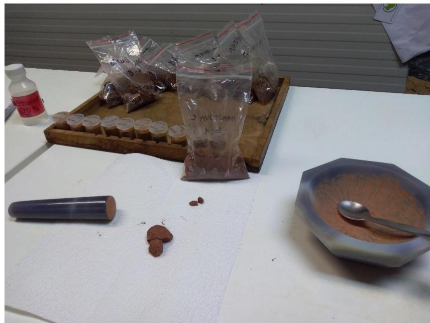
*Slika 7. Pripreme uzorka i usitnjavanje*
