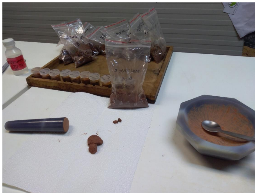
Slika 7. Pripreme uzoraka i usitnjavanje
