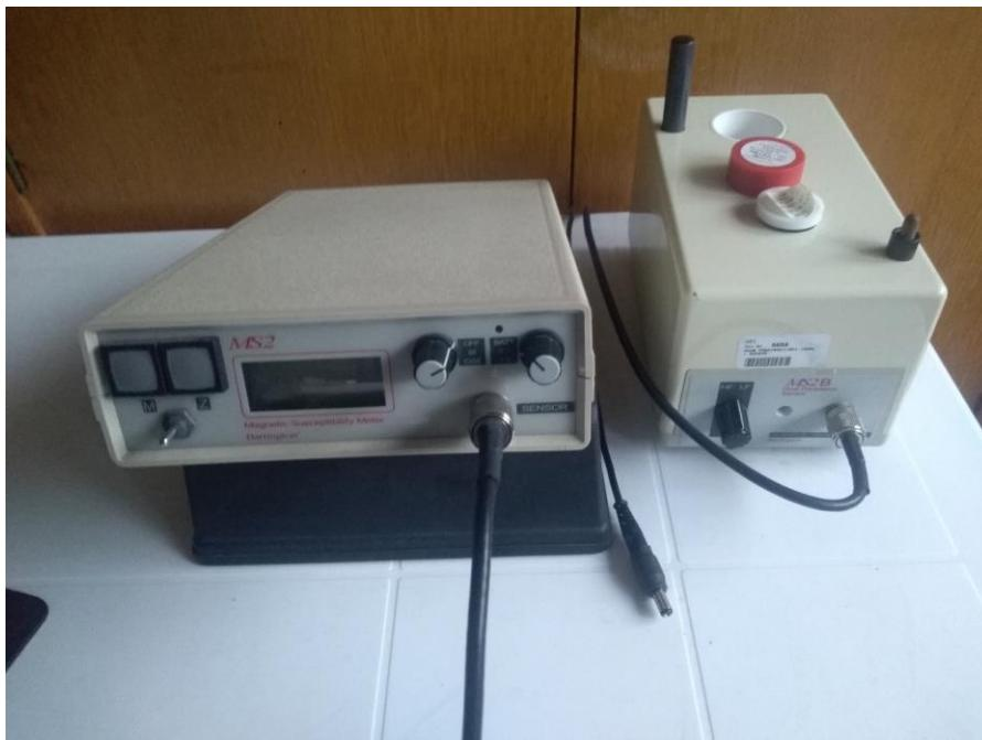
Slika 10. Magnetometar „Bartington MS2“ i senzor „MS2B“
