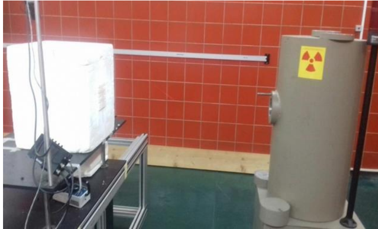
Slika 7.5: sekundarni standardni dozimetrijski laboratorij Instituta „Ruđer Bošković“, Zagreb; na slici se može vidjeti izvor ^{137}\text{Cs} i eksperimentalni postav
