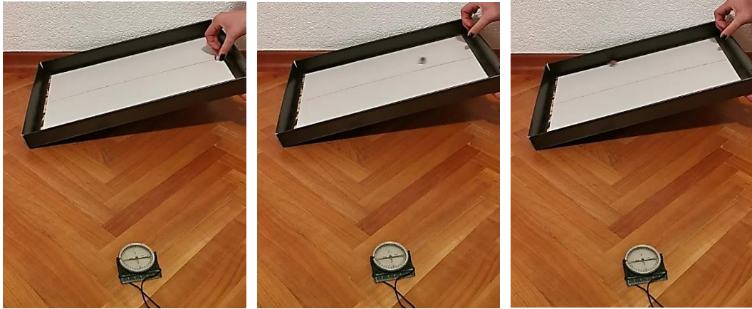
Slika 58 Puštanje magneta niz kosinu koja nije u smjeru istok-zapad
