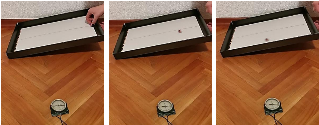
Slika 59 Ponavljamo kao u prethodnom slučaju ali smo magnet okrenuli (zamjena polova)
