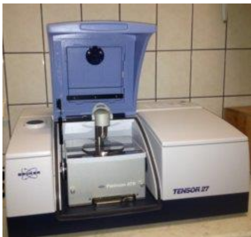
Slika 2: Bruker Tensor 27, ATR spektrometru (Internetski izvor 2)
