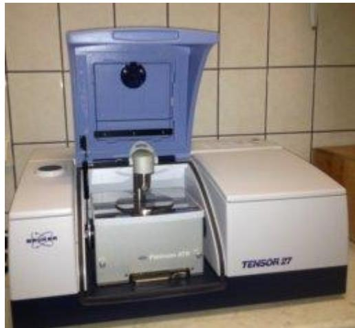
**Slika 2:** Bruker Tensor 27, ATR spektrometru (Internetski izvor 2)
