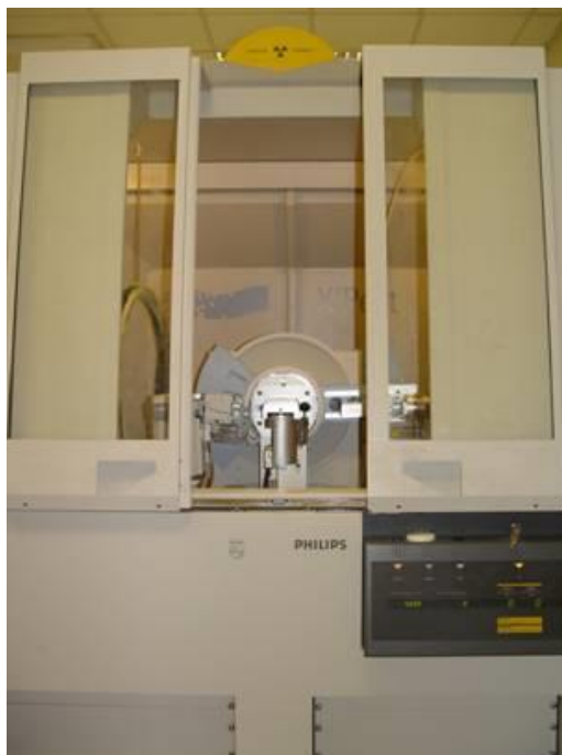
Slika 3: Phillips X'Pert PRO rentgenski uređaj (Internetski izvor 3)
