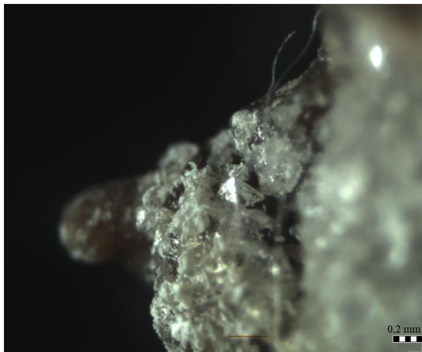
Slika 5: Uzorak SP na kojem se vidi jasno razvijena dipiramida
