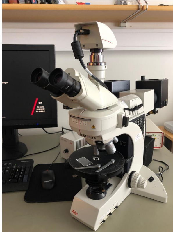
Slika 9. Polarizacijski mikroskop (Leica DMLP) s kamerom (Leica DFC 450) korišteni za rudnu mikroskopiju i slikanje fluidnih inkluzija
