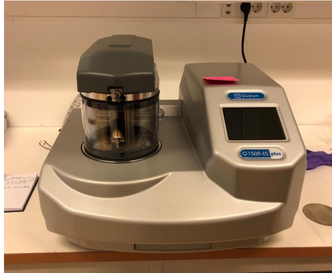
Slika 11. Naparivač (QUORUM Q150R Plus) korišten tijekom pripreme uzoraka za SEM
