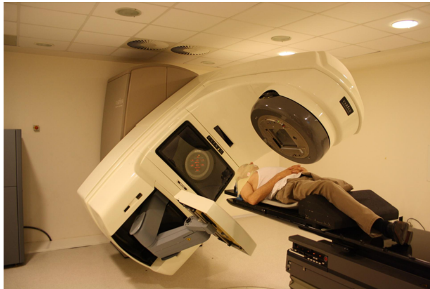
Slika 2.3: Fotografija linearnog akceleratora Varian Clinac DMX u Sveučilišnoj kliničkoj bolnici Mostar, pripremljenog za zračenje pacijenta. Gantry je zarotiran udesno te se pacijent zrači fotonskim snopom pod kutom. U donjem lijevom kutu konfiguracije se vidi poluvodički detektor na robotskoj ruci koji bilježi intenzitet poprečnog presjeka snopa nakon transmisije kroz pacijenta.
