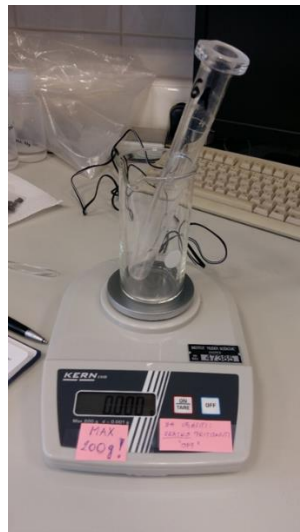
Slika 20. Laboratorijska vaga s 3 decimale. Proizvođač KERN & Sohn GmbH, model EMB 200-3.
