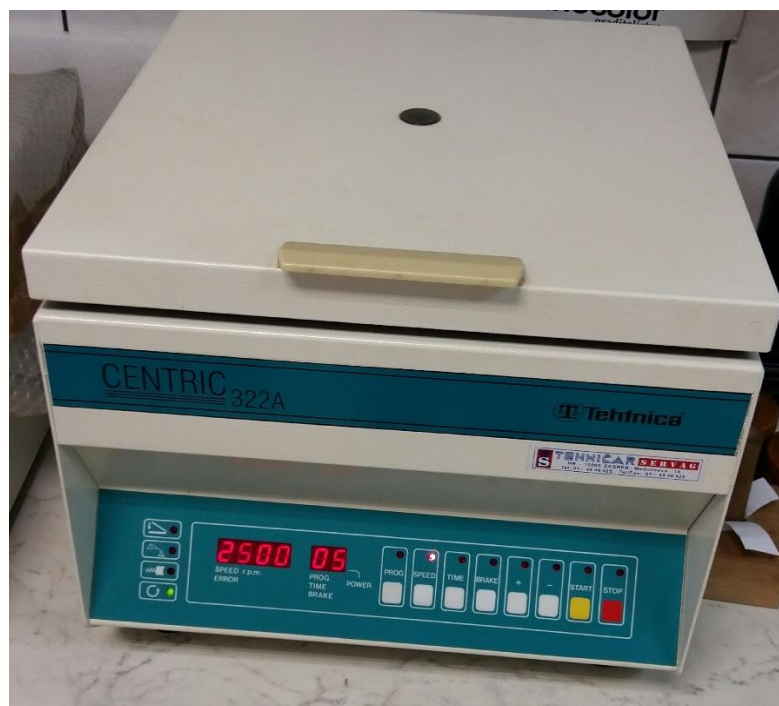
Slika 13. Laboratorijska centrifuga modela Tehnica Centric 322A, proizvođač Domel
