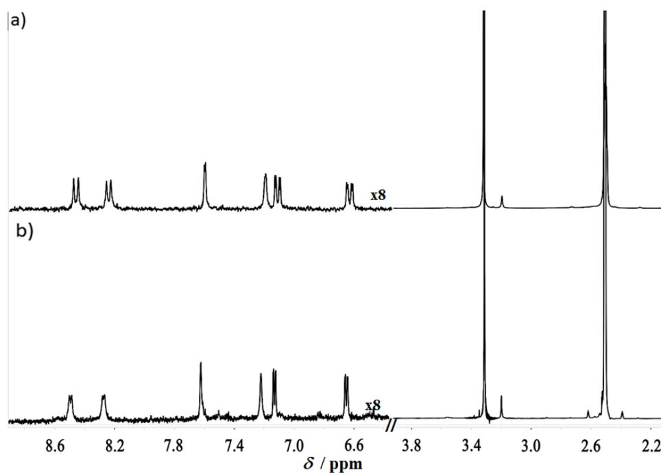
Slika 8.40: Aromatski dio (**lijevo**) i alifatski dio (**desno**) <sup>1</sup>H-NMR spektara produkta **D2-IIIb** dobivenog reakcijom izmjene korištenjem LiCl iz **a) D2-IIa b) D2-Id**. Spektri su snimljeni u DMSO-*d*<sub>6</sub>.
