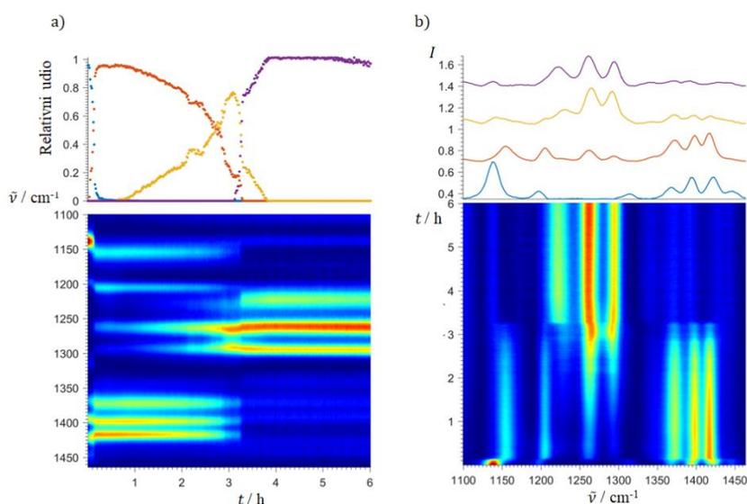
Slika 8.48: *In situ* praćenje ILAG reakcije **L2** s  $\text{trans-}[\text{PdCl}_2(\text{MeCN})_2]$  u množinskom omjeru 1:4 uz NaOAc i DMF kao aditive. Za mljevenje je korištena jedna  $\text{ZrO}_2$  kuglica. Iznad 2D prikaza praćenja reakcije prikazani su **a)** doprinosi pojedinih spektralnih vrsta u vremenu i **b)** prikaz prisutnih spektralnih vrsta dobiveni pomoću MCR-ALS analize.
