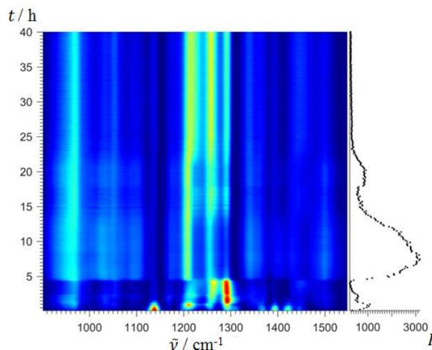
Slika 8.51: 2D prikaz praćenja sinteze spoja **D2-IIa** ILAG-DMF reakcijom **L2** s  $[\text{Pd}(\text{OAc})_2]_3$  u množinskom omjeru 2:3 (lijevo) i intenziteti fluorescencije u čvrstom stanju za vrijeme mjerenja pri  $1700 \text{ cm}^{-1}$ .
