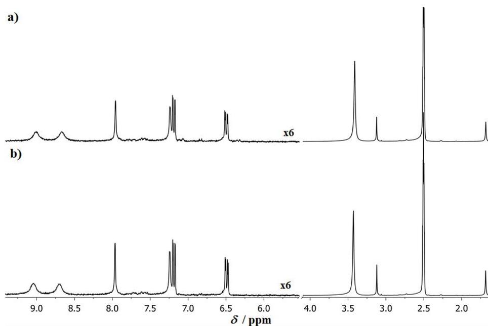
Slika 8.41: Aromatski dio (**lijevo**) i alifatski dio (**desno**) <sup>1</sup>H-NMR spektara produkta **D3-IIIb** dobivenog reakcijom izmjene korištenjem LiCl iz **a) D3-IIa b) D3-Id**. Spektri su snimljeni u DMSO-*d*<sub>6</sub>.
