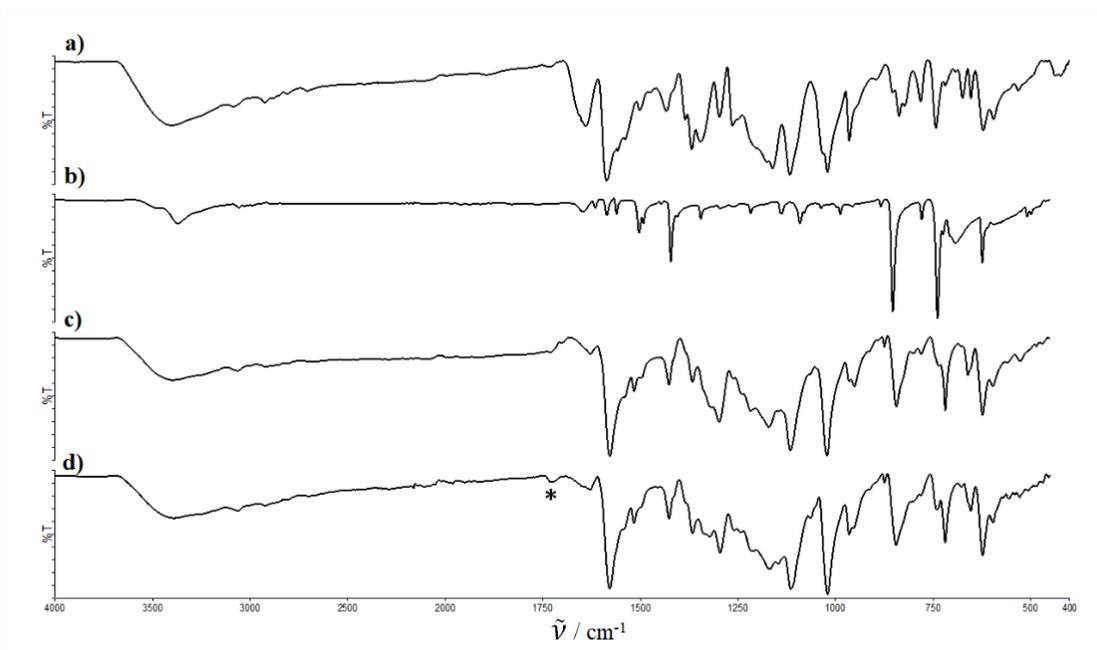
Slika 8.70: IR spektri: a) prekursora **D3-Ib**, b) 1,10-fenantrolina, c) produkta **D3-If**, d) produkta ispranog vodom. Zvezdice u spektru pod d) ukazuju na vrpcu pri 1773  $\text{cm}^{-1}$  koja je pripisana PMMA, materijalu od kojeg je izrađena reakcijska posuda.
