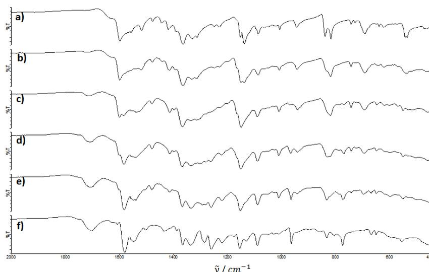
Slika 8.53: IR spektri <sup>1</sup>IAG reakcije **L2** i PdCl<sub>2</sub> s NaOAc kao aditivom u množinskom omjeru 1:4:2 nakon: **a)** 15 min, **b)** 30 min, **c)** 1 h, **d)** 2 h, **e)** 4 h i **f)** 6 h. Reakcijske smjese sadrže malu količinu PMMA od kojeg je izrađena reakcijska posuda, a kojem je pripisana vrpca pri 1723  $\text{cm}^{-1}$ .
