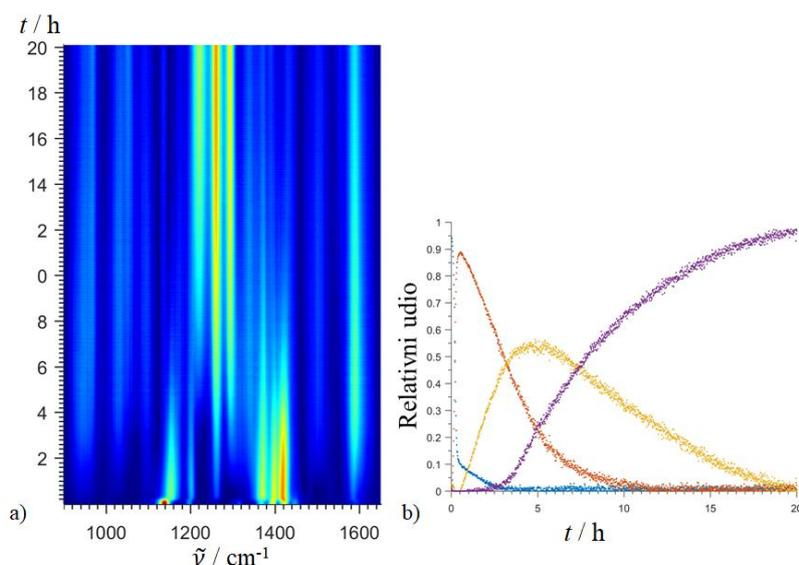
Slika 8.49: *In situ* praćenje ILAG reakcije **L2** s  $\text{trans-}[\text{PdCl}_2(\text{MeCN})_2]$  u množinskom omjeru 1:4 uz NaOAc i DMF kao aditive. Za mljevenje je korištena jedna čelična kuglica: **a)** 2D prikaz praćenja reakcije i **b)** doprinosi pojedinih spektralnih vrsta u vremenu. Za dovršetak reakcije bilo je potrebno 20 sati.
