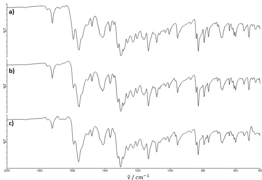
Slika 8.59: IR spektri produkta **M2-IIa** dobivenog mljevenjem **L2** s  $[\text{P}(\text{OAc})_2]_3$  u množinskom omjeru 3:1 uz dodatak DMF-a nakon **a)** 7 h (prisutna **forma III**), **b)** nakon 12 h (prisutna **forma I**) i **c)** nakon 20 h (prisutna **forma II**).
