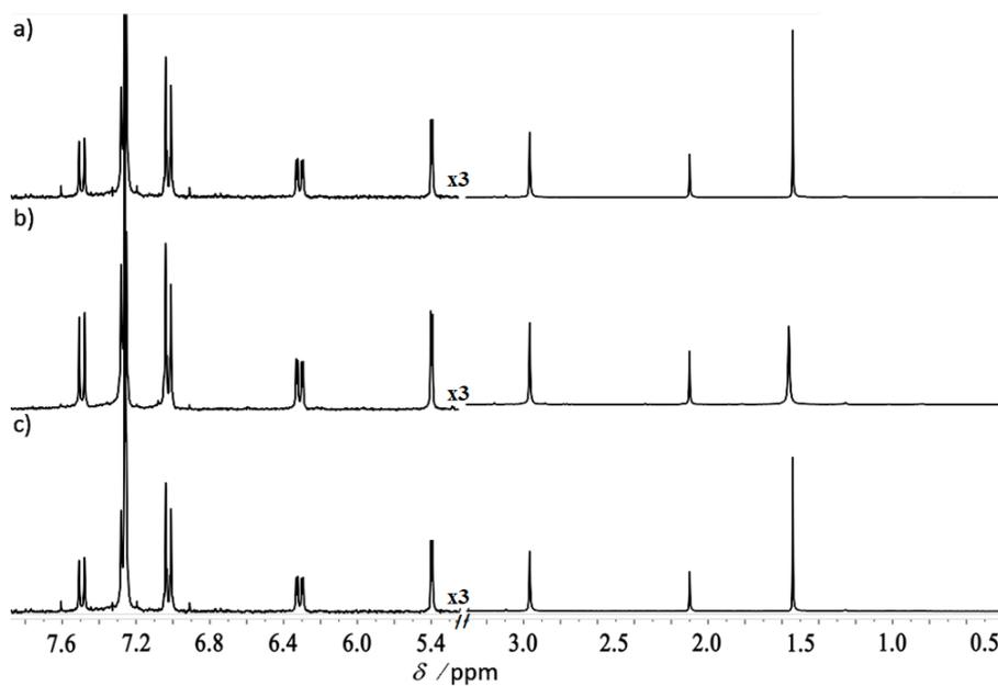
Slika 8.33: Aromatski dio (**lijevo**) i alifatski dio (**desno**)  $^1\text{H}$ -NMR spektara produkta **M2 $\alpha$ -IIa** dobivenog reakcijom izmjene korištenjem NaOAc iz **a) M2 $\alpha$ -IIb** **b) M2 $\alpha$ -Ic** i **c) M2 $\alpha$ -Id** Spektari su snimljeni u  $\text{CDCl}_3$ .
