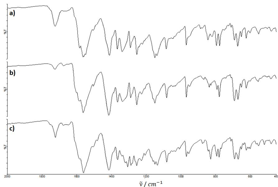
Slika 8.60: IR spektri **D2-IIa** dobivenog mehanokemijskom reakcijom uz dodatak **a)** DMF-a nakon 21 h (**forma II**), **b)** dodatak DMF-a nakon 30 h (**forma I**) i **c)** dodatka vode nakon 22 h (smjesa formi).
