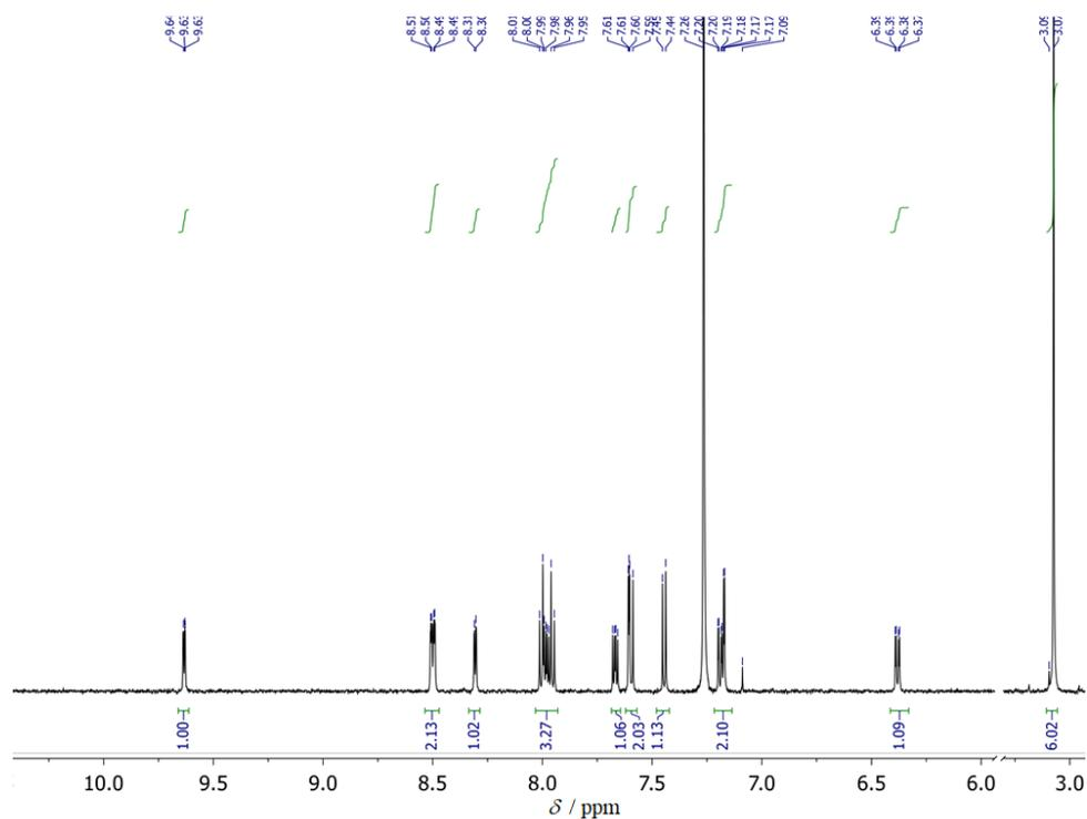
Slika 8.45:  $^1\text{H-NMR}$  spektar produkta **D2-If** snimljen u  $\text{CDCl}_3$ .
