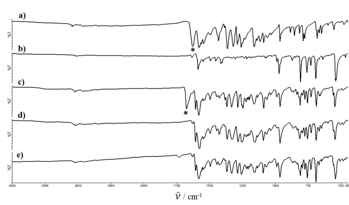
Slika 8.67: IR spektri: **a)** prekursora **D3-Ib**, **b)** 4-stirilpiridina **c)** produkta **D3-Ie**, **d)** produkta ispranog vodom, **e)** produkta prekrizaliziranog iz MeOH. Zvezdice u spektrima a) i c) ukazuju na vrpcu pripisanu vibraciji istezanja karbonilne skupine *N,N*-dimetilformamida.
