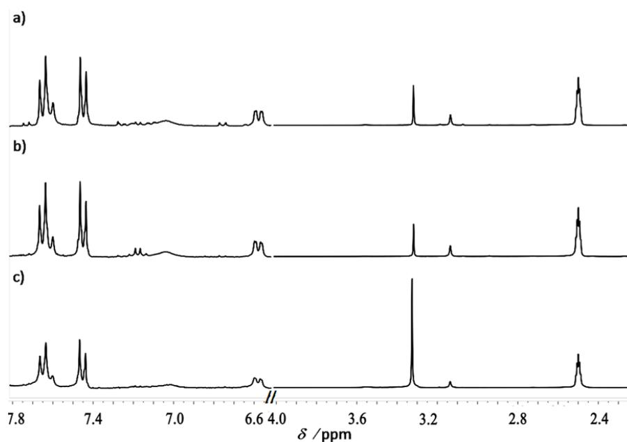
Slika 8.38: Aromatski dio (**lijevo**) i alifatski dio (**desno**)  $^1\text{H}$ -NMR spektara produkta **M2 $\alpha$ -IIIb** dobivenog reakcijom izmjene korištenjem LiCl iz **a) M2 $\alpha$ -IIa b) M2 $\alpha$ -Ic i c) M2 $\alpha$ -Ib** Spektri su snimljeni u DMSO- $d_6$ .
