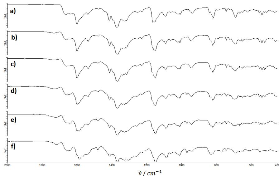
Slika 8.55: IR spektri praćenja ILAG reakcije **L2** i  $\text{trans-}[\text{PdCl}_2(\text{MeCN})_2]$  s NaOAc (u množinskom omjeru 1:4:2) i 15  $\mu\text{L}$  DMF nakon: **a)** 15 min, **b)** 30 min, **c)** 1h, **d)** 2 h, **e)** 4 h i **f)** 6 h mljevenja.
