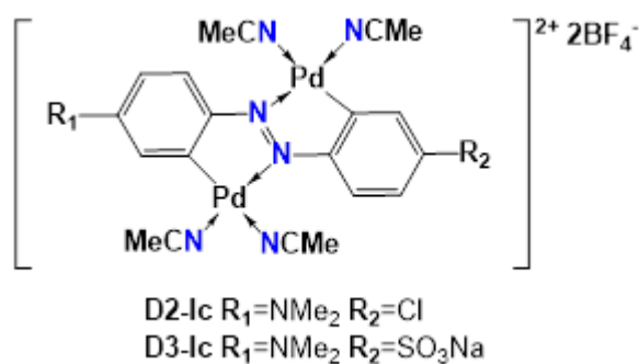
Slika 3.6: Produkti starenja [\text{Pd}(\text{MeCN})_4][\text{BF}_4]_2 s ligandima L2 i L3 .
