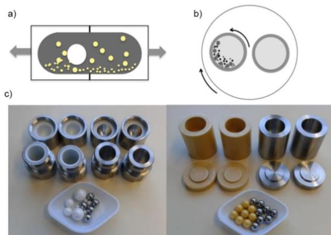
Slika 2.7: Shematski prikaz rada a) vibracijskog mlina i b) planetarnog mlina, c) prikaz reakcijskih posuda za vibracijski mlin i kuglica za mljevenje od različitih materijala.<sup>84</sup>
