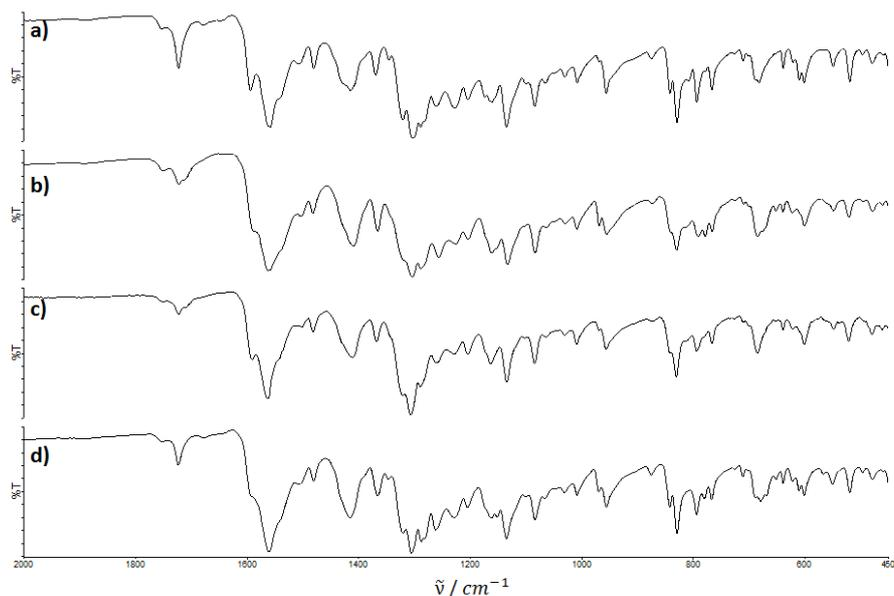
Slika 8.57: IR spektri: monociklopaladiranog produkta **M2-IIa** dobivenog reakcijom mljevenja uz dodatak **a)** DMF-a (**forma III**), **b)** MeCN **c)** HOAc i **d)** H<sub>2</sub>O. Vrpca pri 1723  $\text{cm}^{-1}$  pripisana je materijalu od kojeg je izrađena reakcijska posudica, PMMA.
