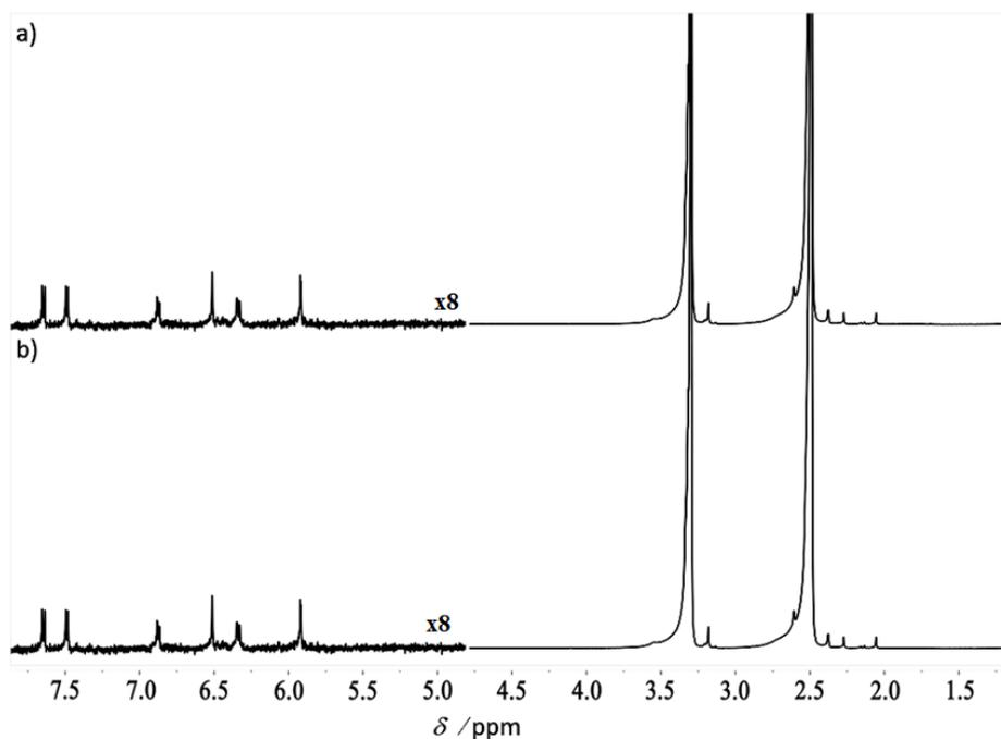
Slika 8.35: Aromatski dio (**lijevo**) i alifatski dio (**desno**) <sup>1</sup>H-NMR spektara produkta **D2-IIa** dobivenog reakcijom izmjene korištenjem NaOAc iz **a) D2-IIB** i **b) D2-Id**. Spektri su snimljeni u DMSO-*d*<sub>6</sub>.
