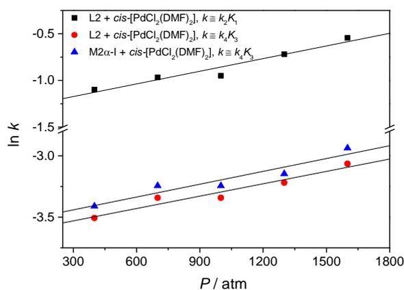
Slika 8.72: Eyringov prikaz tlačne ovisnosti konstanti drugog reda za reakcije ciklopaladacije **L2** i drugoj ciklopaladaciji monopaladiranog **M2 $\alpha$ -Ib**.
