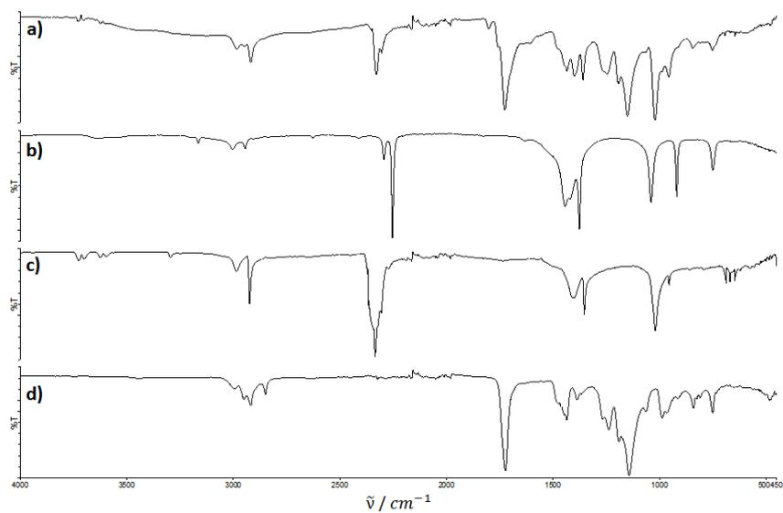
Slika 8.56: IR spektri: **a)** reakcijske smjese nakon 2 sata mljevenja  $\text{PdCl}_2$  uz dodatak MeCN, **b)** MeCN, **c)**  $\text{trans-}[\text{PdCl}_2(\text{DMF})_2]$  i **d)** PMMA od kojeg je izrađena reakcijska posuda.
