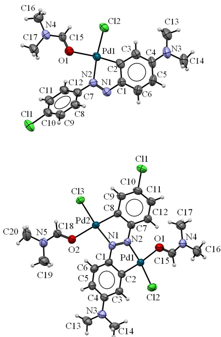
Slika 4.55: ORTEP prikaz molekulske strukture spojeva **M2 $\alpha$ -Ib** (gore) i **D2-Ib** (dolje). Elipsoidi termalnih pomaka atoma nacrtani su s vjerojatnošću od 50%, a vodikovi atomi prikazani bijelim kuglicama.
