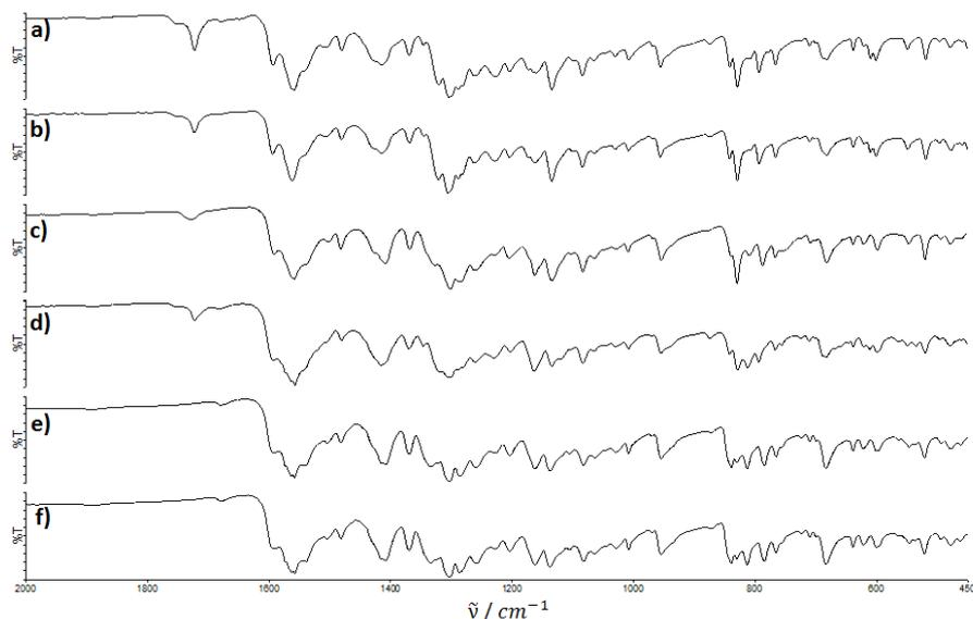
Slika 8.58: IR spektri **M2-IIa** dobivenog ILAG-DMF reakcijom: **a)** produkt (**forma III**), **b)** produkt ispran vodom, **c)** isprani produkt prekrizaliziran iz kloroforma, **d)** isprani produkt prekrizaliziran iz ledene octene kiseline, **e)** isprani produkt prekrizaliziran iz DMF i **f)** **M2-IIa** dobiven sintezom u otopini.
