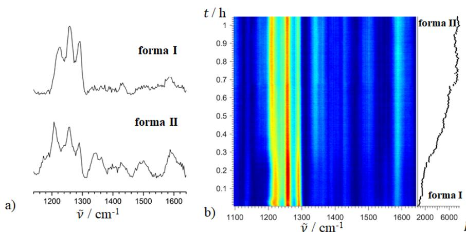
Slika 8.52: a) Raman spektri različitih formi kompleksa **D2-IIa**, b) 2D prikaz praćenja transformacije **forme I** kompleksa **D2-IIa** dobivenog ILAG- $\text{H}_2\text{O}$  metodom u **formu II** nakon dodatka  $15 \mu\text{L}$  DMF-a u reakcijsku smjesu (lijevo). Intenziteti fluorescencije u čvrstom stanju za vrijeme mjerenja pri  $1700 \text{ cm}^{-1}$  pokazuju da **forma II** fluorescira jače od **forme I**.
