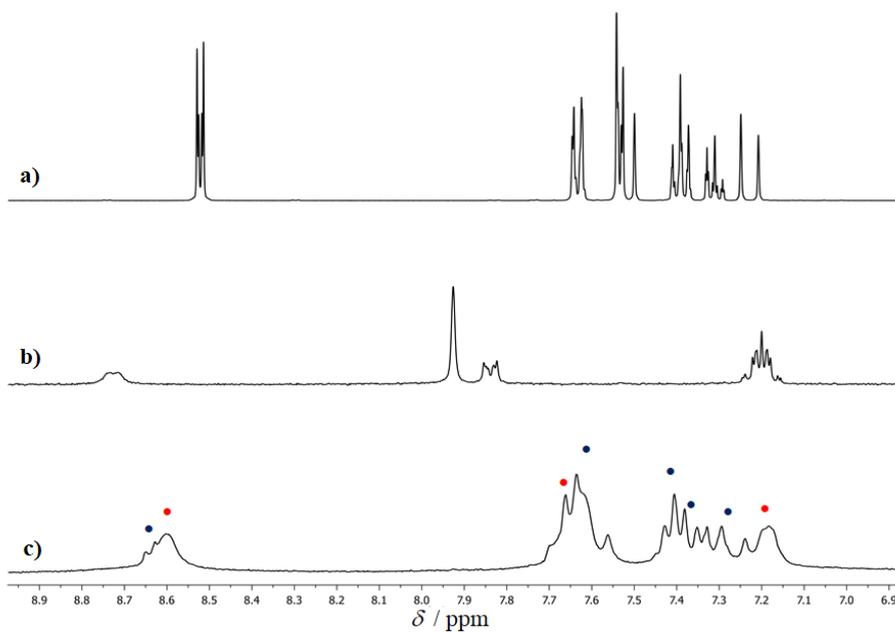
Slika 8.43: Aromatski dio  $^1\text{H}$ -NMR spektara snimljeni u  $\text{DMSO}-d_6$ : a) 4-stirilpiridin, b) **D1-Ib** i c) **D1-Ie**. Crvenim krugovima označeni su signali liganda **L1**, a plavim 4-stirilpiridina.
