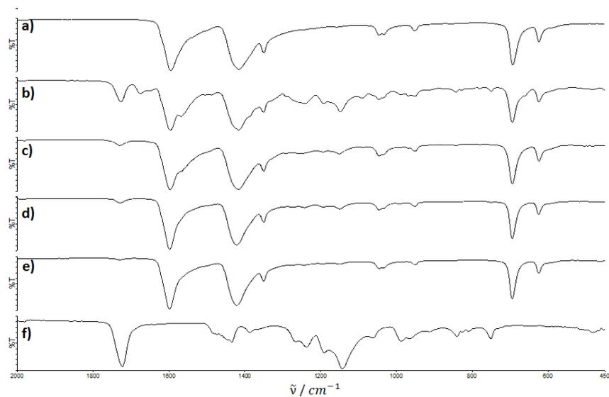
Slika 8.61: IR spektri: **a)**  $[\text{Pd}(\text{OAc})_2]_3$ , te produkata nakon 2 sata mljevenja  $[\text{Pd}(\text{OAc})_2]_3$  s **b)** DMF-om, **c)** H<sub>2</sub>O, **d)** HOAc, **e)** MeCN te **f)** spekter PMMA (materijal od kojeg je izrađena reakcijska posudica).
