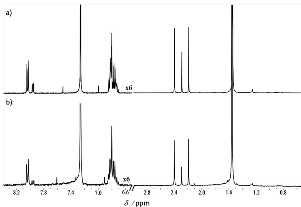
Slika 8.34: Aromatski dio (**lijevo**) i alifatski dio (**desno**) <sup>1</sup>H-NMR spektara produkta **D1-Ia** dobivenog reakcijom izmjene korištenjem NaOAc iz **a) D1-IIIb** i **b) D1-Id**. Spektri su snimljeni u CDCl<sub>3</sub>.
