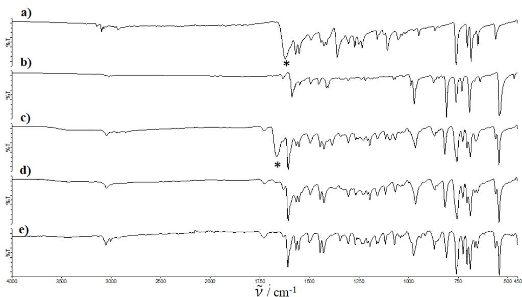
Slika 8.65: IR spektri: **a)** prekursor **D1-Ib**, **b)** 4-stirilpiridina, **c)** produkt **D1-Ie**, **d)** produkt ispran vodom, **e)** produkt prekrizaliziran iz MeOH. Zvezdice u spektrima a) i c) ukazuju na vrpcu pripisanu vibraciji istezanja karbonilne skupine *N,N*-dimetilformamida.
