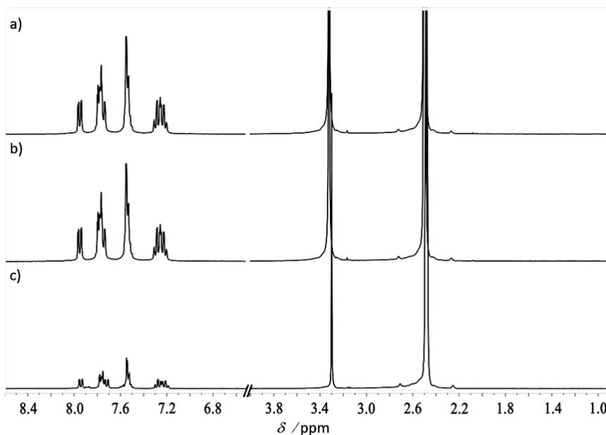
Slika 8.37: Aromatski dio (**lijevo**) i alifatski dio (**desno**) <sup>1</sup>H-NMR spektar produkta **M1-IIb** dobivenog reakcijom izmjene korištenjem LiCl iz a) **M1-IIa** b) **M1-Ic** i c) **M1-Id**. Spektri su snimljeni u DMSO-*d*<sub>6</sub>.
