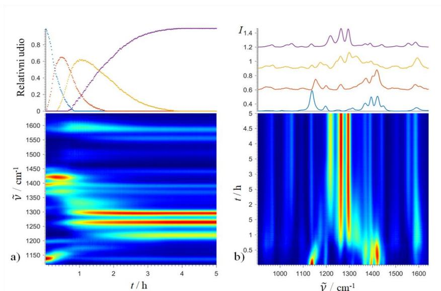
Slika 8.47: *In situ* praćenje ILAG reakcije **L2** s  $\text{PdCl}_2$  u množinskom omjeru 1:4 uz NaOAc i DMF kao aditive. Za mljevenje je korištena jedna čelična kuglica. Iznad 2D prikaza praćenja reakcije prikazani su **a)** doprinosi pojedinih spektralnih vrsta u vremenu i **b)** prikaz prisutnih spektralnih vrsta dobiveni pomoću MCR-ALS analize. Produkt **D2-IIIb** dobiven je za 4,5 h.
