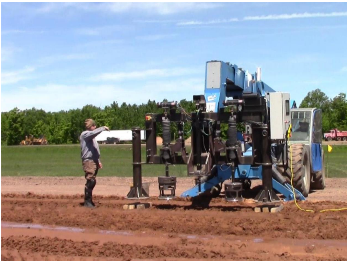
Sl. 17. Terensko mjerenje bevametrom montiranim na buldožer
