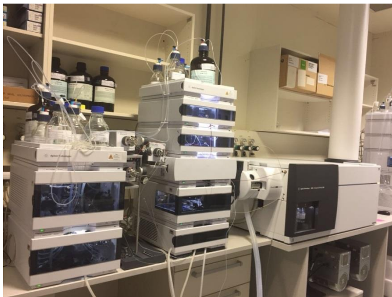
Slika 12. Tekućinski kromatograf ultravisoke djelotvornosti vezan sa spektrometrom masa visoke razlučivosti (2D-UHPLC-Q-TOF)
