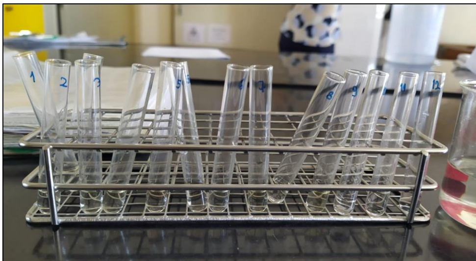
Slika 13. Uzorci i slijepa proba u semimikroeprevetama prije zagrijavanja
