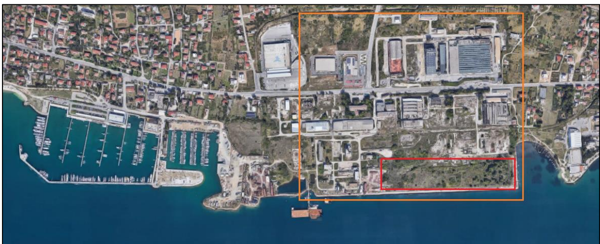
Slika 8. Narančastim kvadratom označeno je područje tvornice, a crvenim kvadratom taložnica pepela i šljake s povišenim koncentracijama aktivnosti prirodnih radionuklida (izvor: https://www.google.com/maps/ )
