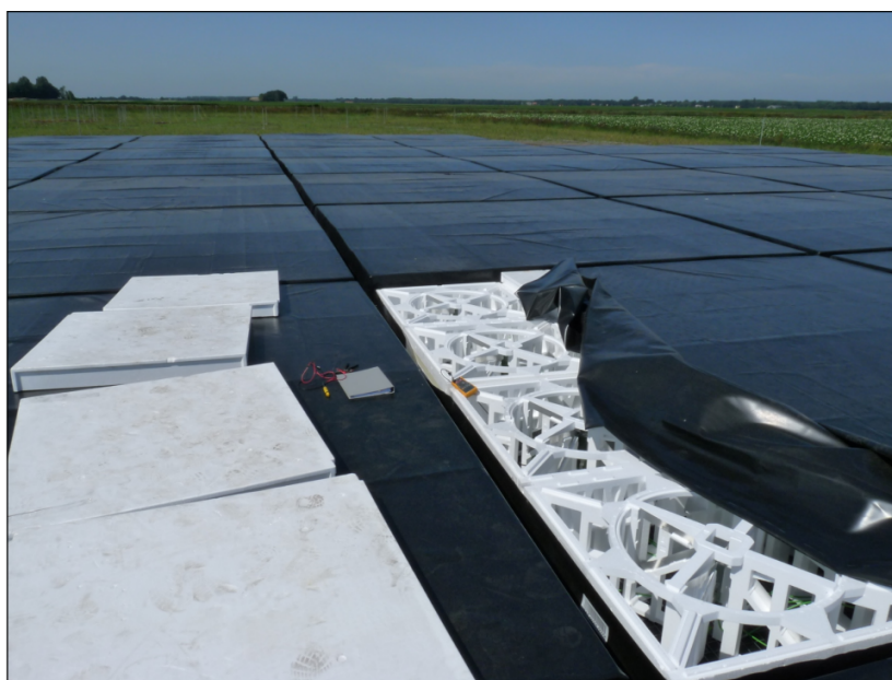
Slika 2.1. Fotografija jedinice visokopojasne antene teleskopa LOFAR. Zaštitna navlaka je djelomično odmaknuta kako bi se vidio dizajn dipolne antene i kružni mehanizam za rotaciju dipola [1].
