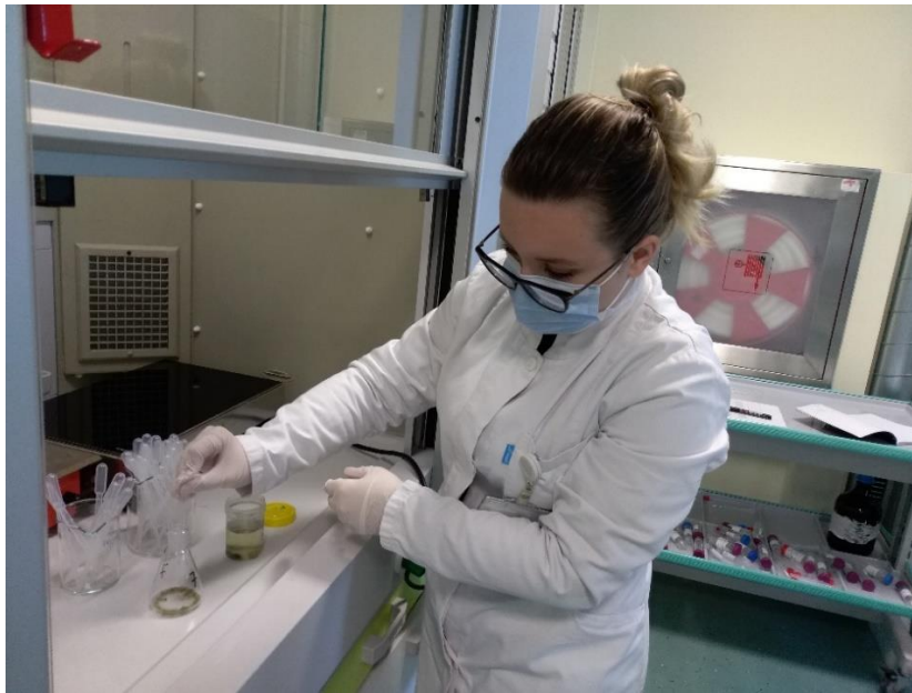
Slika 12. Premještanje 3 mL uzorka kapalicom iz čaše u Erlenmeyerovu tikvicu (autor: Lucija Kanjer)
