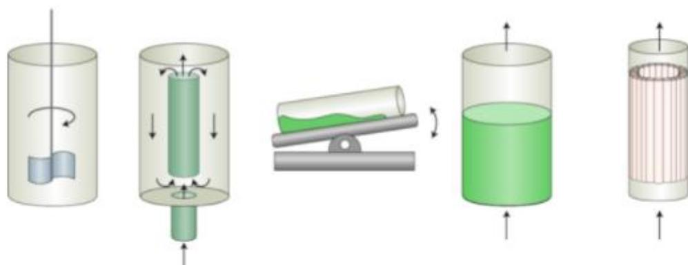
Slika 4. Različiti tipovi industrijskih biorektora za uzgoj stanica sisavaca. S lijevog na desno prikazani su: bioreaktor za miješanje medija, *airlift*, ljuljajući/njhajući bioreaktor, *fluidized bed* i bioreaktor s vlaknima (Post i sur., 2020).
