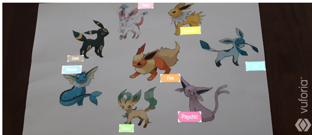
Slika 3.3: Prepoznavanje više ciljanih slika odjednom (slike likova) i prikaz virtualnih slika (slika s tekstom)
