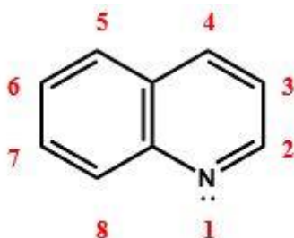
Slika 1. Strukturna formula i numeriranje atoma molekule kinolina
