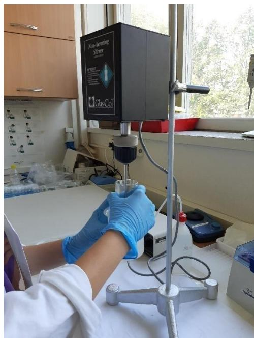
**Slika 6.** Homogeniziranje tkiva probavne žlijezde školjkaša pomoću homogenizatora s teflonskim batićem pričvršćenim na rotirajuću osnovu (snimila dr. sc. Dušica Ivanković).
