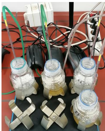
Slika 4. Dvije bočice od 100 mL sa suspenzijom 4K, perlitom i LB medijem (žuta tekućina) te dvije bočice od 100 mL sa suspenzijom 4K, perlitom i LB/10 medijem (prozirna tekućina) stavljene na aeraciju 24 h te pričvršćene za podlogu.
