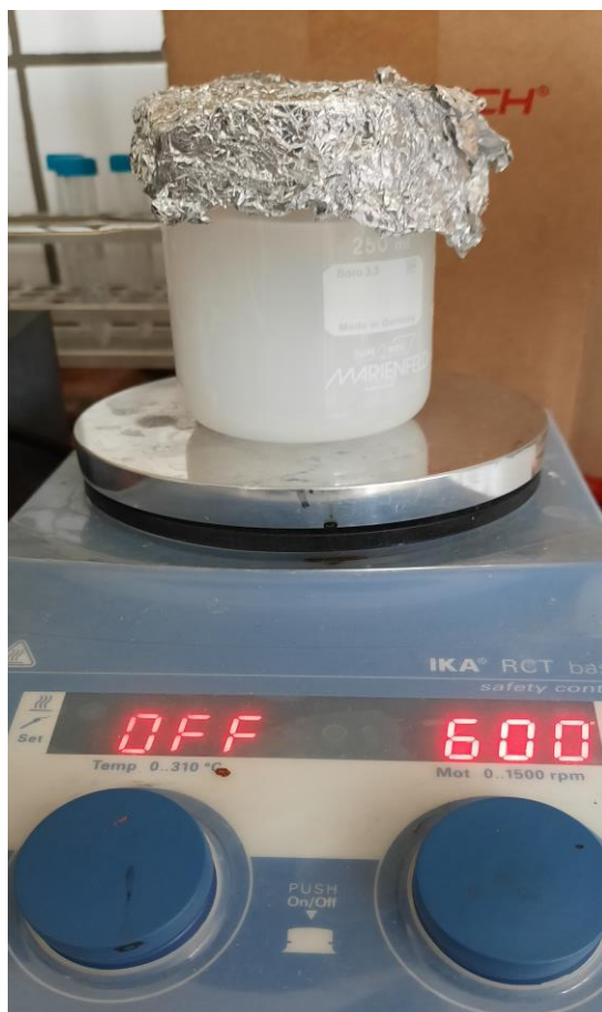
Slika 10. Fotografija aparature tijekom sinteze \text{SiO}_2 sfera standardnim Stöberovim procesom
