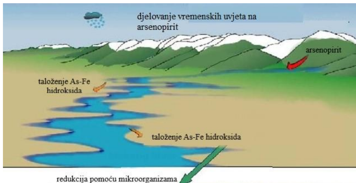
Slika 6. Pojednostavljeni prikaz izmjene i transporta arsena od arsenopirita do vode namjenjene za piće. Preuzeto i prilagođeno iz literaturnog izvora 26.
