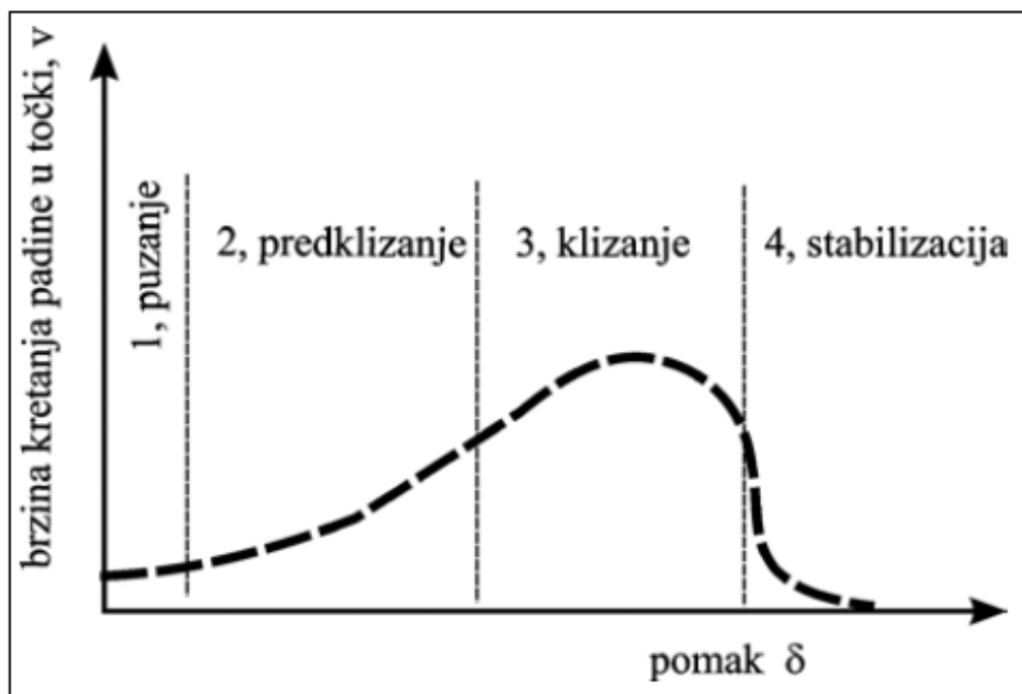
Slika 1. Faze pomicanja tla na padini na kojoj dolazi do nastanka klizišta
