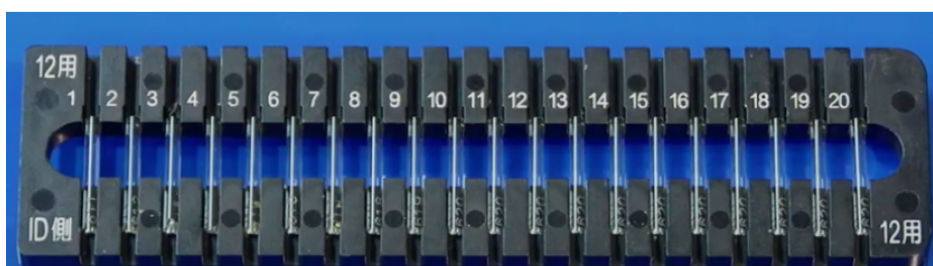
Slika 3.7: Čitač Dose Ace FGD-1000 (gore) i stalak na koji se postavljaju detektori (dolje). Slika je preuzeta iz [10]
