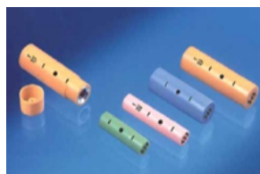
Slika 3.6: Plastični držači. U radu su korišteni plastični držači s filterom za kompenzaciju energijske ovisnosti (žuti).
