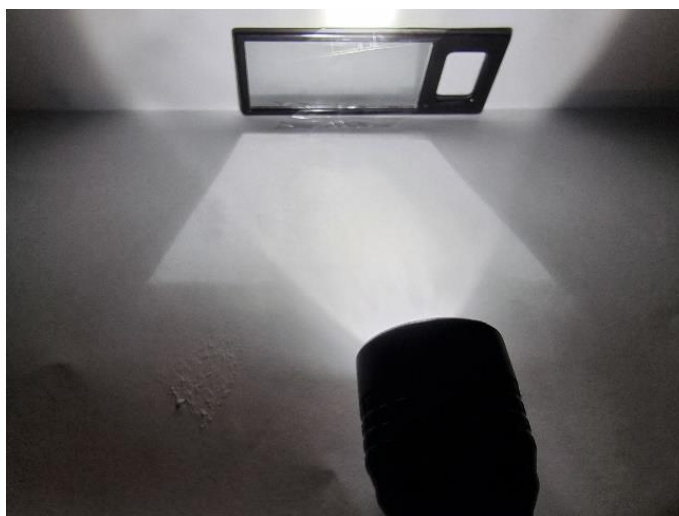
Slika 7. Zrake svjetlosti padaju okomito na zrcalo
