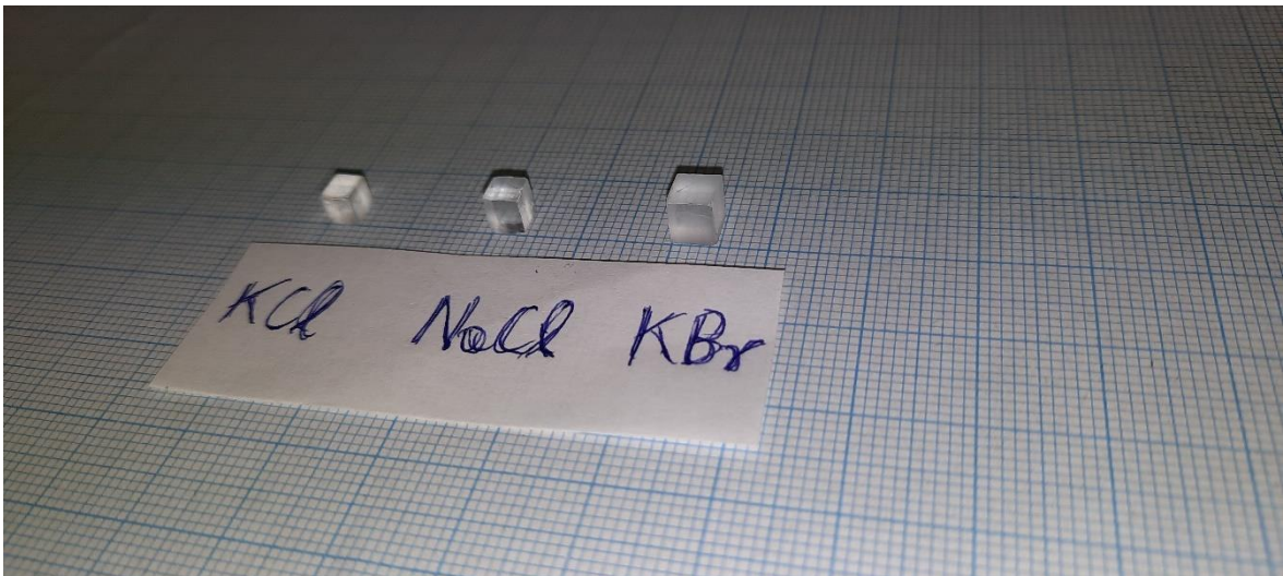
Slika 18. Kristali KCl , NaCl i KBr . Dimenzije kristala KCl su: x = 3.6 mm, y = 3.9 mm, z = 3.4 mm. Dimenzije kristala NaCl su: x = 4.0 mm, y = 3.9 mm, z = 4.8 mm. Dimenzije kristala KBr su: x = 4.8 mm, y = 5.3 mm, z = 4.9 mm ( x = duljina, y = širina, z = visina). Kristali su postavljeni između magneta tako da su duljine stranice kroz koje prolazi svjetlost za KCl = 3.6 mm, za NaCl = 4.0 mm, a za KBr = 4.8 mm.
