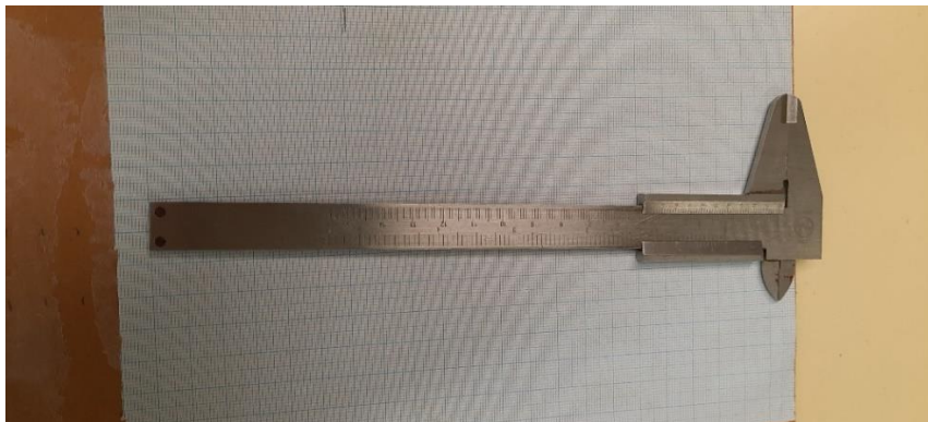
Slika 19. Pomično mjerilo s preciznošću 0.1 mm.
