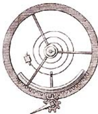
Slika 2.2: Mehanizam sata sa spiralnom oprugom [24]
