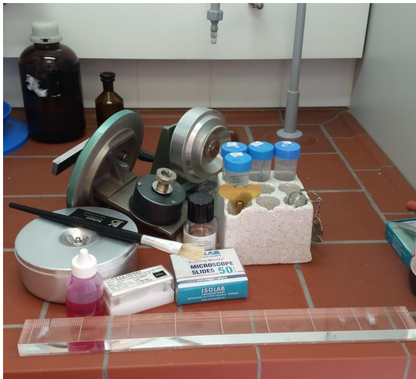
Slika 16. Pribor i kemikalije koje se koriste za uzorkovanje i pripremu aerobiološku mikroskopskih preparata (foto: A. Vucić)
