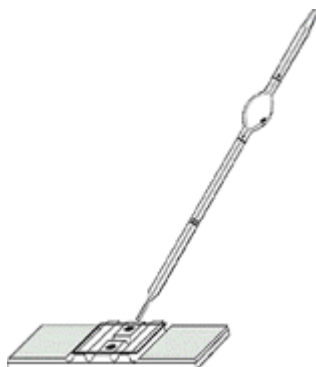
Slika 6. Nanošenje uzorka u Fuchs-Rosenthal-ovu komoricu (preuzeto s: www.laboroptik.de ).
