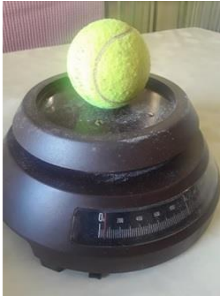
Slika 29. Mjerenje mase loptice
